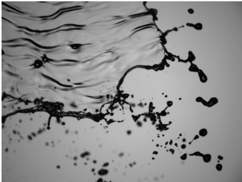
Figura 01: Formação de gotas através de ponta de pulverização
