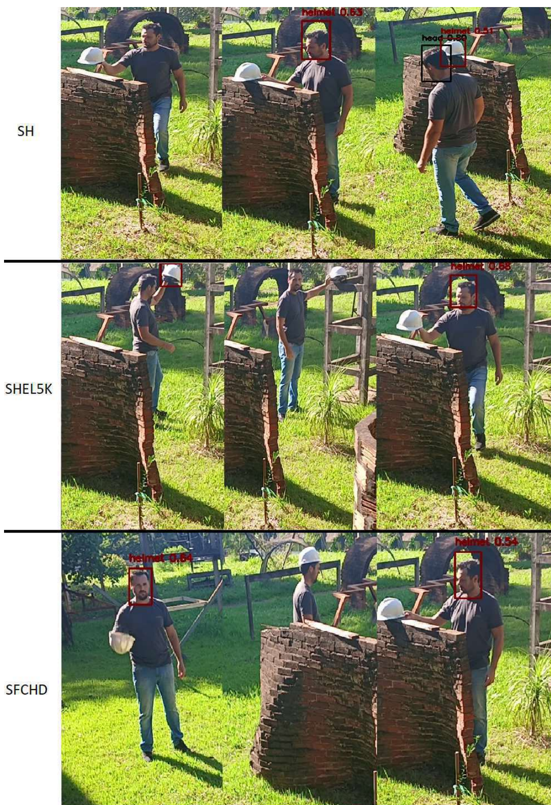
Figura 21 – Quadros de imagem do vídeo 2. Imagens em situações de falhas de detecções a partir dos modelos YOLO12s treinados nos datasets SH, SHEL5K e SFCHD.
