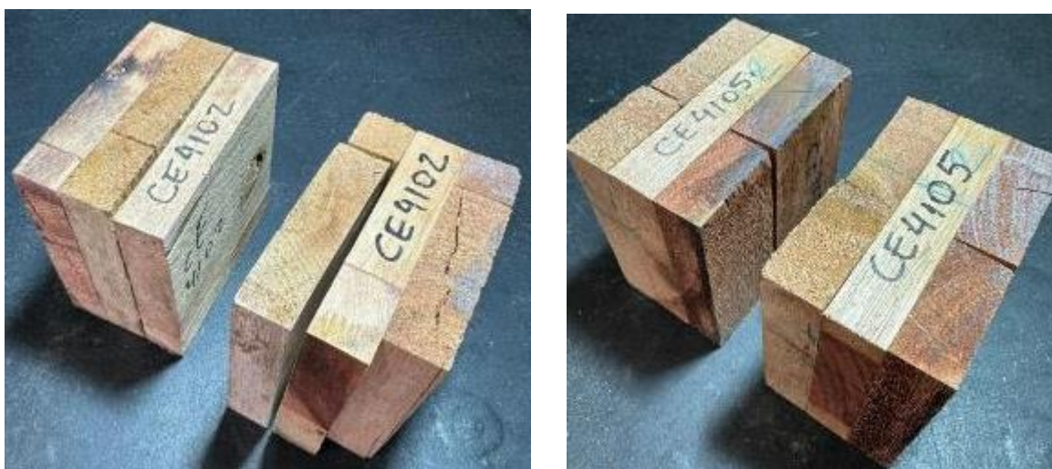
Figura 94 . Corpos de prova retirados do painel CE4102 e CE4105 ensaiados a delaminação. Fonte: Autor.
