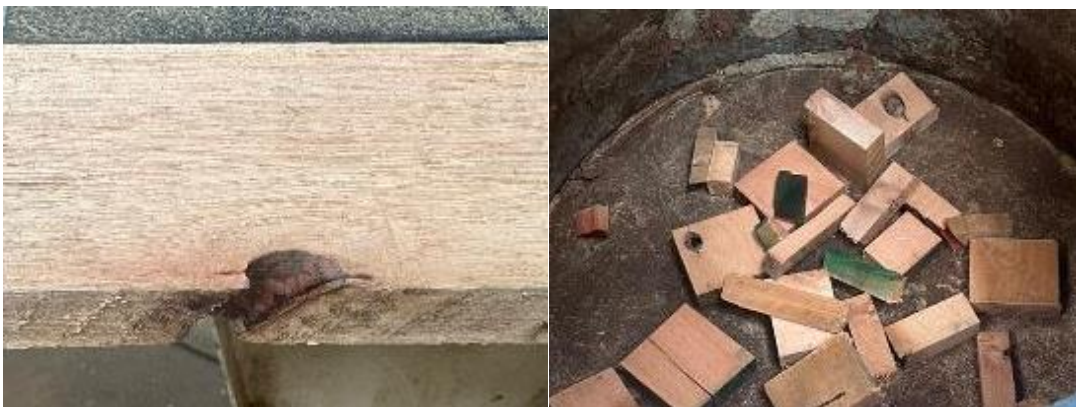
Figura 30 Defeitos retirados das tabuas. Fonte: Autor.
