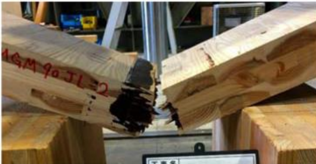
Figura 23 Modo de ruptura do painel com 3 camadas. Fonte: KOMATSU et. al (2021)
