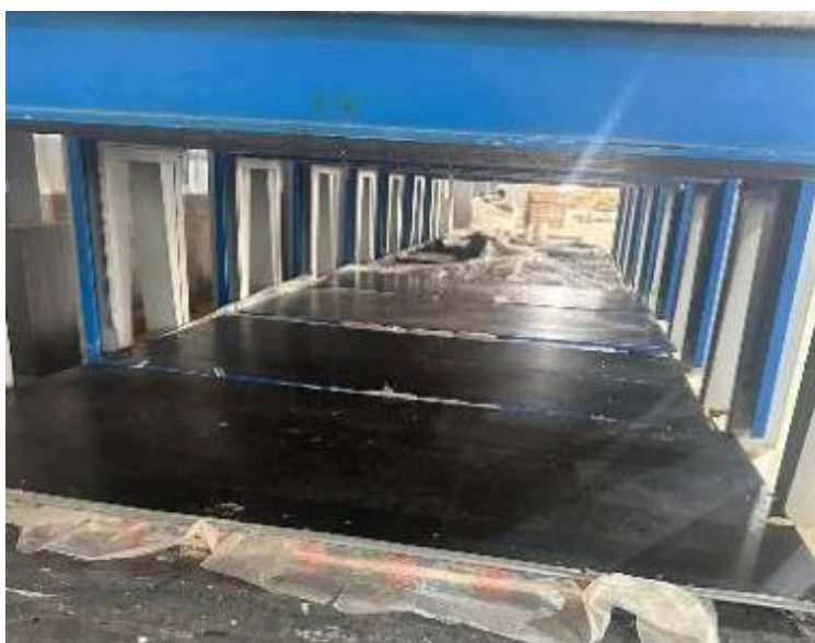
Figura 41 Painéis MLCC montados antes da prensagem. Fonte: Autor
