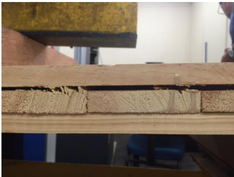
Figura 21 Painel MLCC detalhe da falha na linha de cola. Fonte: ALENCAR (2015)
