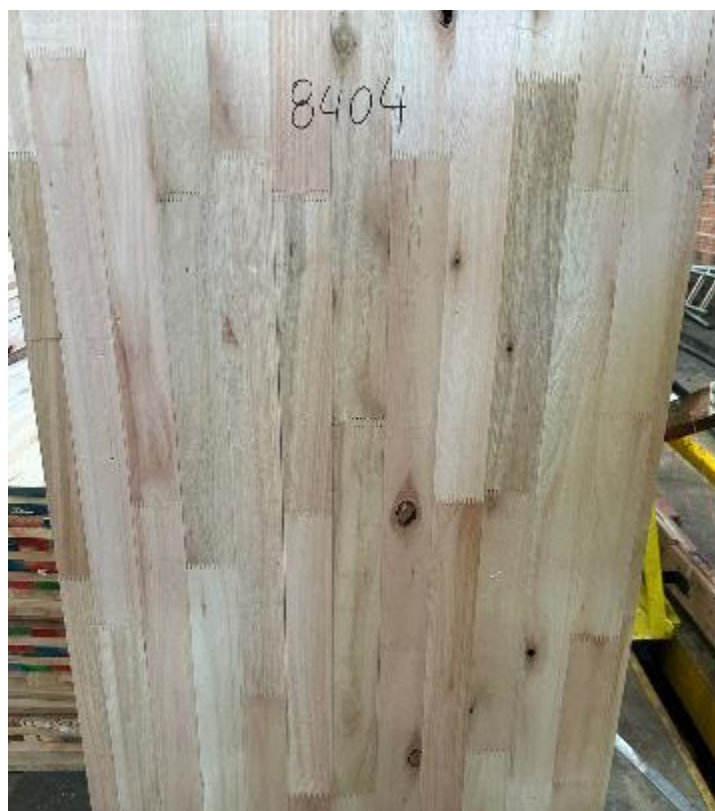
Figura 73 Painel CE8404 rompeu por descolamento de camada. Fonte: Autor
