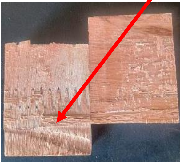
Figura 82 Modo de fratura dos corpos de prova do ensaio de cisalhamento. Fonte: Autor
