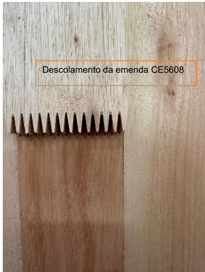
Figura 61 Modo de ruptura dos painéis nos ensaios de flexão. Fonte: Autor
