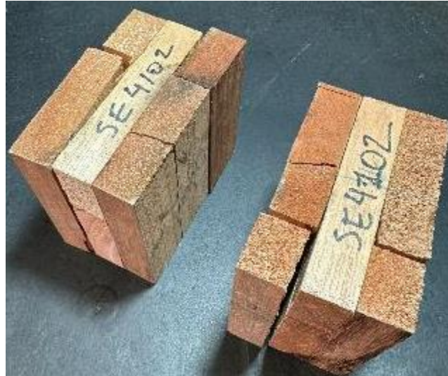
Figura 108 Corpos de prova ensaiados do painel SE4102 e ensaiados a delaminação. Fonte: Autor
