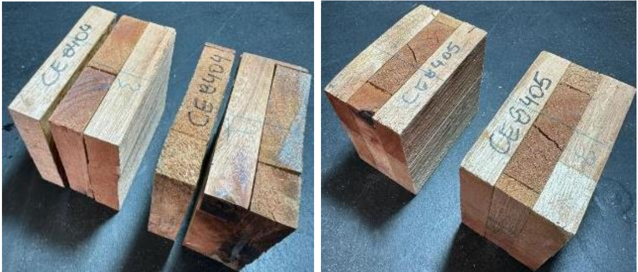
Figura 103 Corpos de prova ensaiados a delaminação extraídos do grupo dos painéis sem emenda. Fonte: Autor
