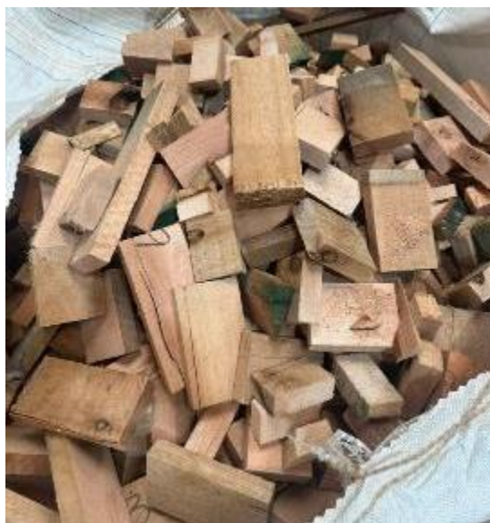
Figura 52 Resíduos proveniente da retirada dos defeitos das tábuas. Fonte: Autor
