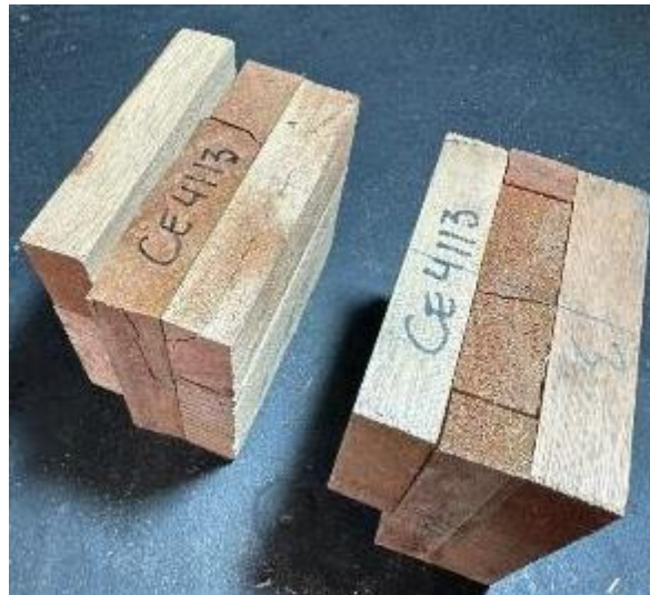
Figura 96 Corpos de prova retirados do painel CE4113 ensaiados a delaminação. Fonte: Autor.
