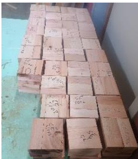
Figura 49 corpos de prova para ensaios de delaminação. Fonte: Autor
