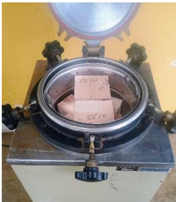
Figura 50 Corpos de prova dentro da autoclave para os ensaios de delaminação. Fonte: Autor
