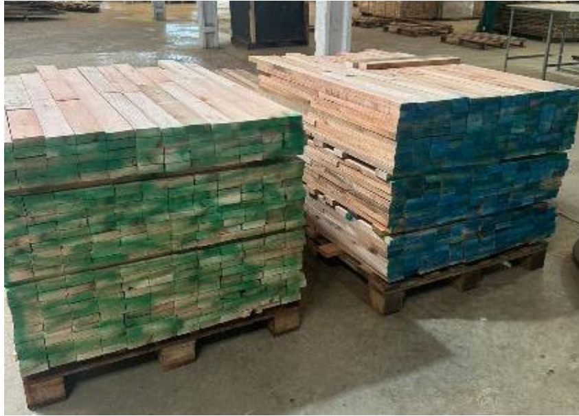
Figura 31 Peças reagrupadas e marcadas nos grupos de MOE pós corte. Fonte: Autor
