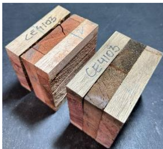
Figura 95 Corpos de prova retirados do painel CE4103 ensaiados a delaminação. Fonte: Autor.
