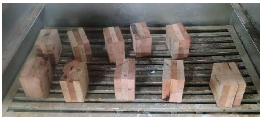
Figura 51 Secagem em estufa dos corpos de prova dos ensaios de delaminação. Fonte: Autor
