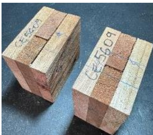
Figura 100 Corpos de prova retirados do painel CE5609 ensaiados a delaminação. Fonte: Autor.
