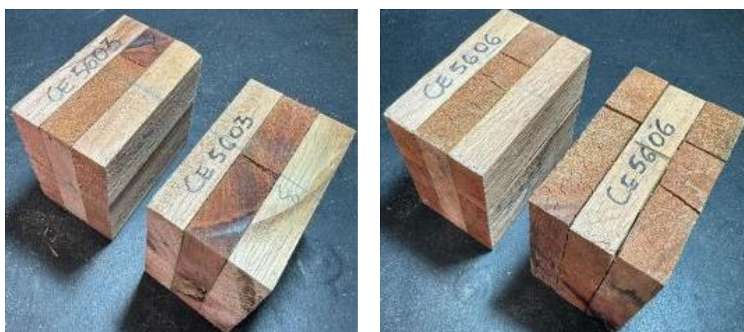
Figura 99 Corpos de prova retirados do painel CE5603 e CE5606 ensaiados a delaminação. Fonte: Autor.
