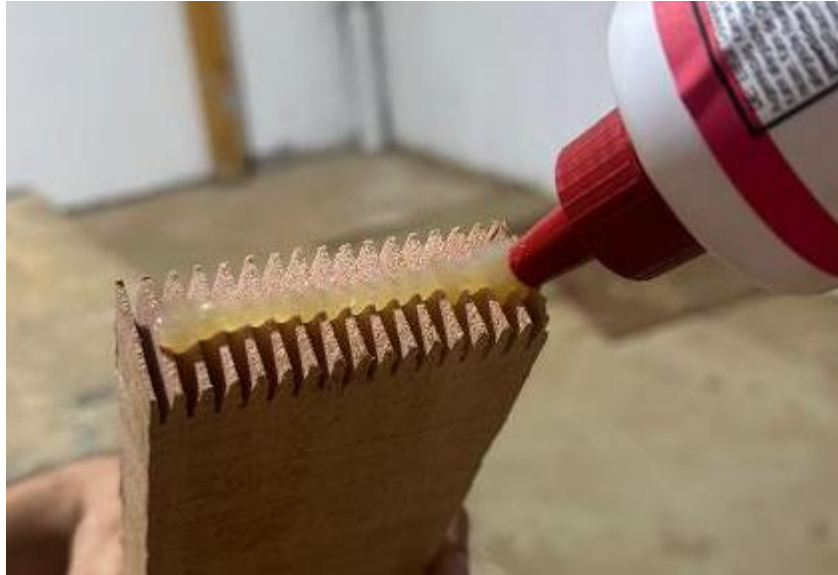
Figura 35 Aplicação do adesivo PU monocomponente na emenda. Fonte: Autor
