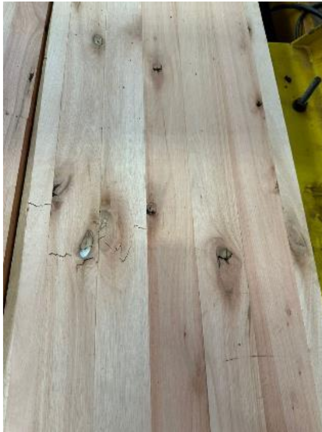
Figura 78 Painel SE 5601 demonstrando modo de ruptura nos nós e na madeira. Fonte: Autor
