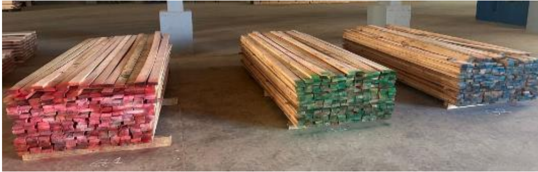
Figura 29 Grupos classificados de acordo com o MOE das tábuas. Fonte: Autor.
