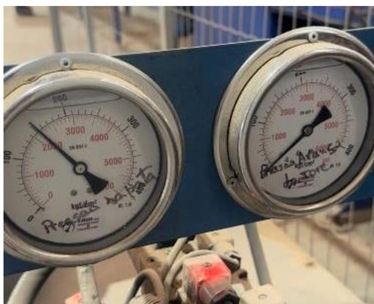
Figura 34 Medidor da pressão da colagem das emendas. Fonte: Autor
