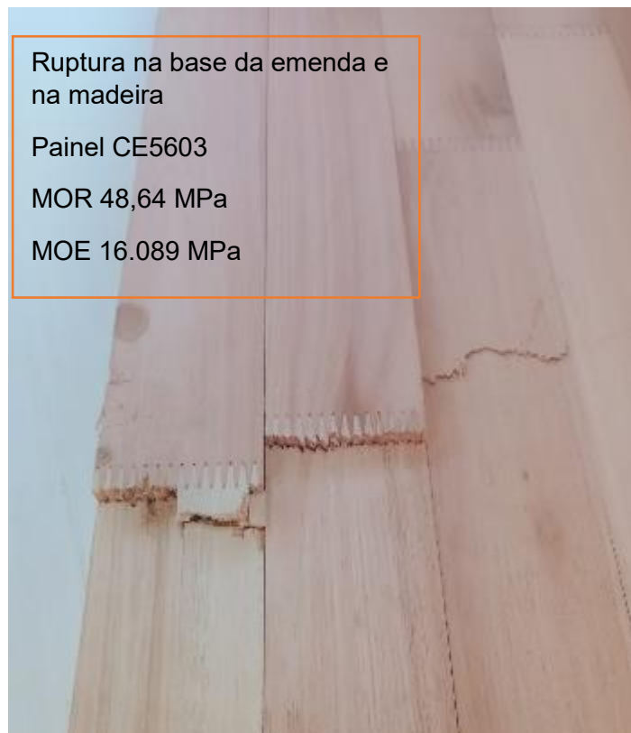
Figura 68. Painel CE5603 demonstrando ruptura na base da emenda e na madeira. Fonte: Autor
