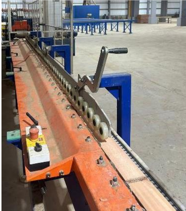
Figura 36 Equipamento semiautomático de produção de emendas dentadas. Fonte: Autor
