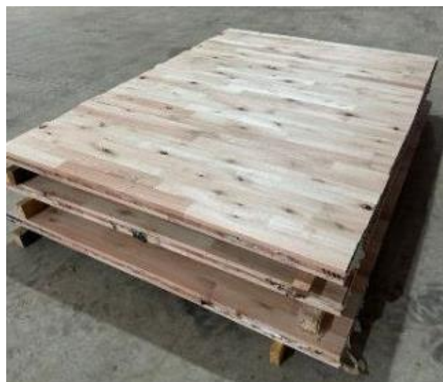
Figura 43 Painéis após a prensagem. Fonte: Autor
