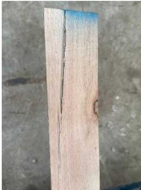
Figura 27 Exemplo de defeito retirado (rachadura). Fonte: Autor.
