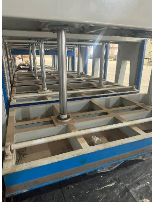
Figura 42 Prensagem dos Painéis MLCC. Fonte: Autor
