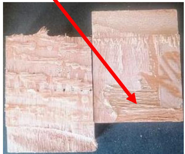
Figura 82 Modo de fratura dos corpos de prova do ensaio de cisalhamento. Fonte: Autor
