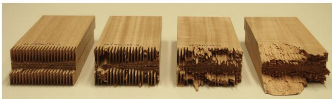
Figura 17 Modo de ruptura dos corpos de prova. Tipo 1 – 2 – 3 – 4. Fonte: BOCANEGRA et. al (2017)
