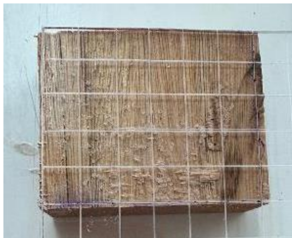
Figura 48 Análise da porcentagem de fratura no corpo de prova. Fonte: Autor
