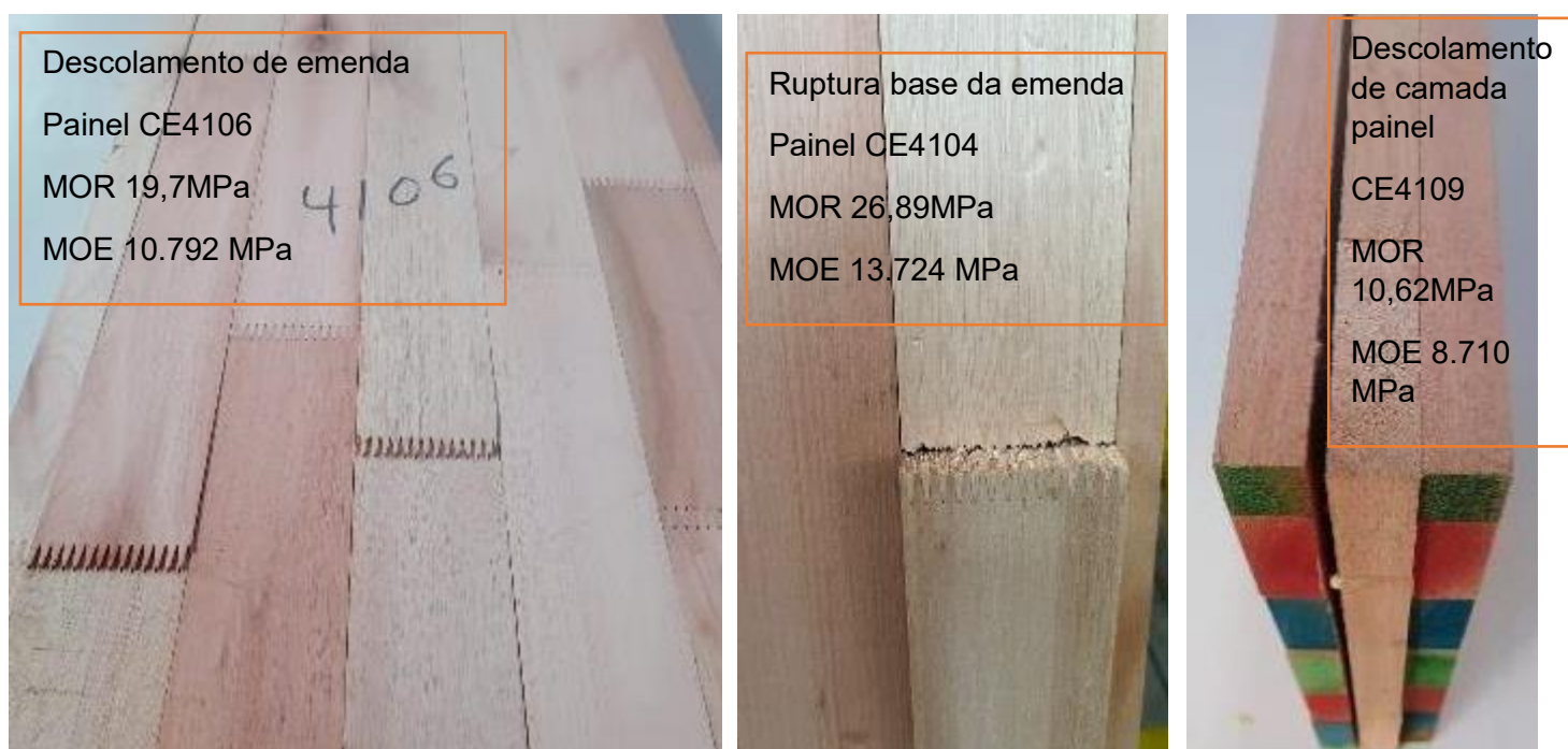
Figura 63. Modo de ruptura dos painéis CE4106, CE4104 e CE4109. Fonte: Autor
