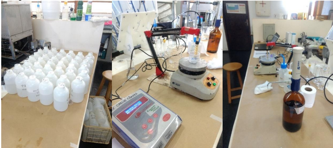
Figura 10 - Procedimentos Laboratoriais da Potenciometria Direta no quantitativo da concentração de flúor na água.
