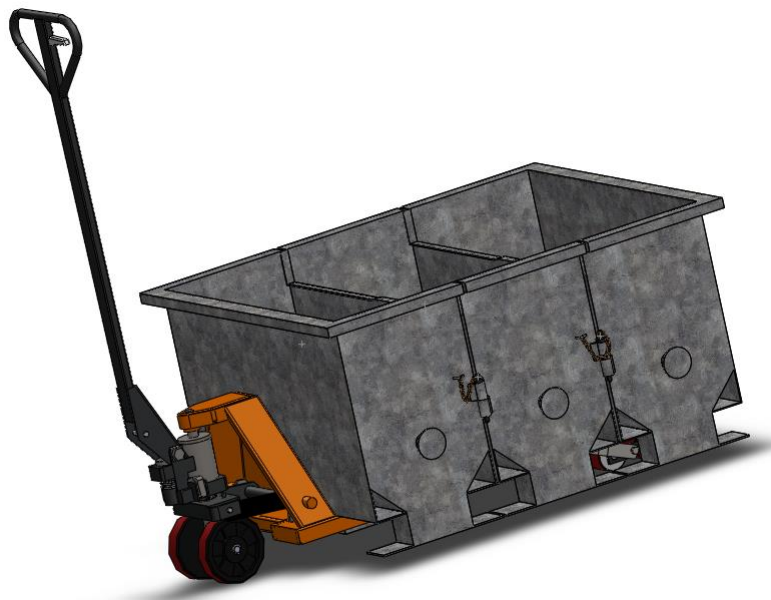
Figura 69 – Conjunto A-B-B DO CPMA transportado por carrinho paleteiro convencional – vista lateral
