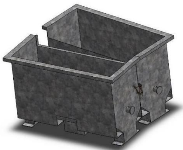
Figura 39 – Contentor paletizado modular antitransbordante – Montagem A-B
