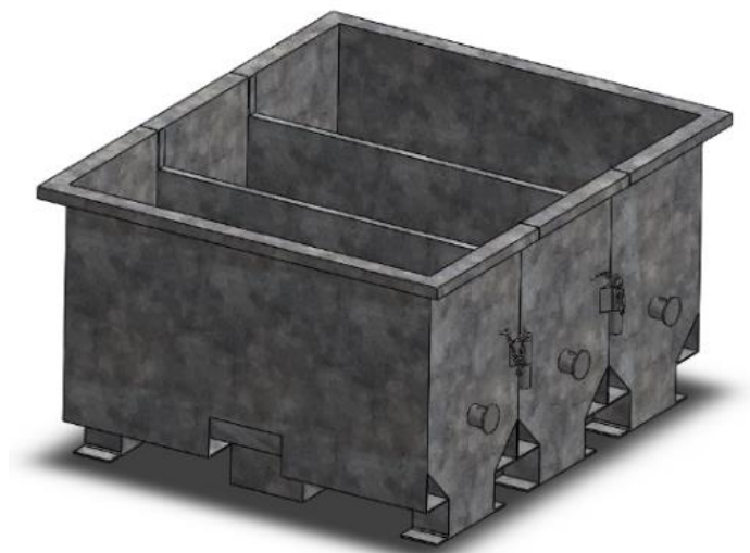
Figura 40 – Contentor paletizado modular antitransbordante – Montagem A-B-C
