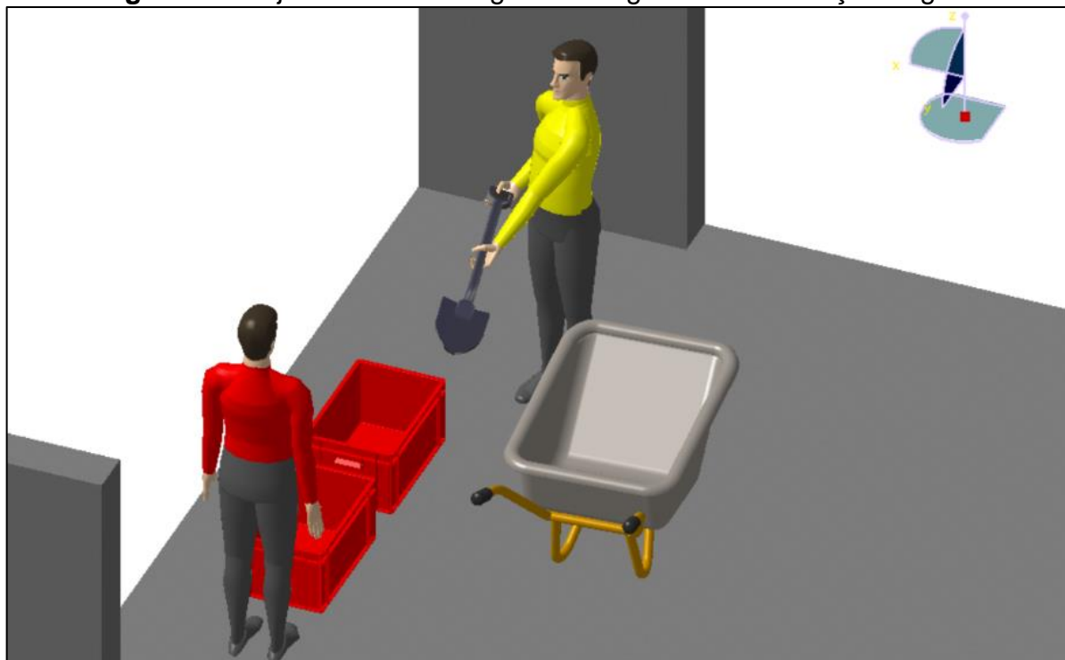
Figura 54 – Ajudante descarregando a argamassa – situação original
