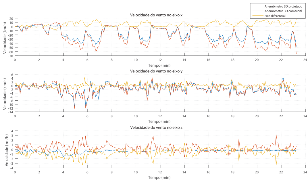
Figura 4.20 – Teste com o anemômetro ortogonal com o eixo X posicionado em paralelo com a frente do automóvel.
