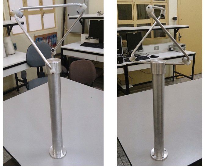
Fig. 4. Anemômetro ultrassônico tridimensional desenvolvido.
