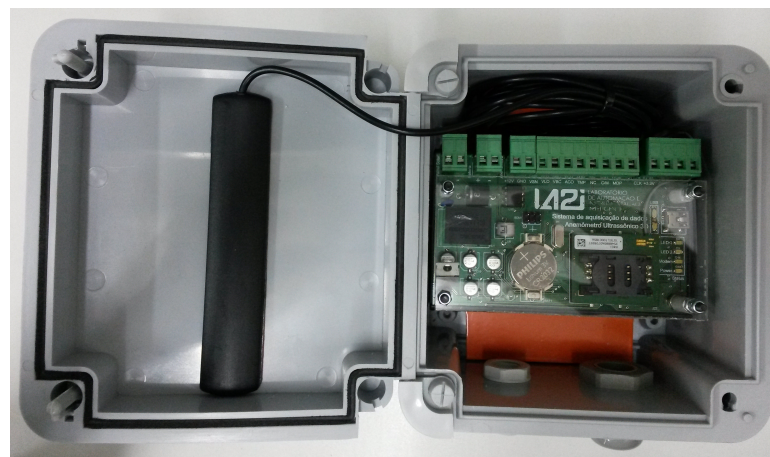
Figura 4.10 – Montagem em caixa plástica da placa de circuito impresso do sistema de aquisição de dados.
