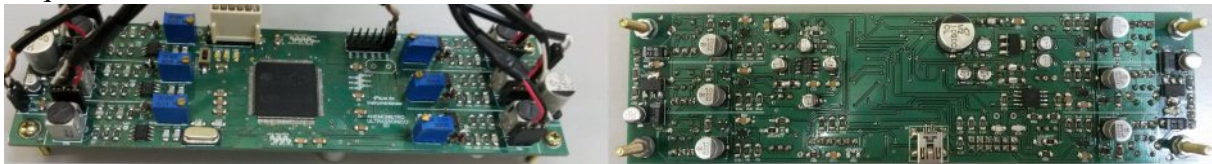
Figura 4: Placa de instrumentação eletrônica do anemômetro projetado.
