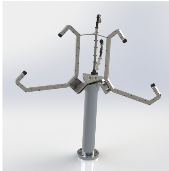
Figura 3.10 – Anemômetro projetado em software de modelagem 3D com topologia não ortogonal.
