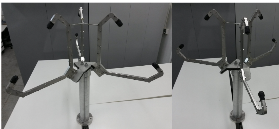
Figura 4.8 – Protótipo de anemômetro ultrassônico 3D com topologia não ortogonal.
