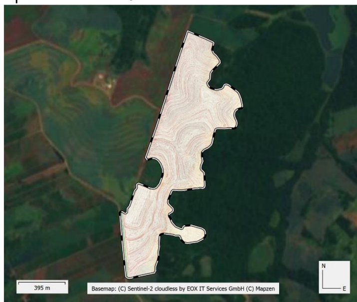
Figura 11 – Ortomosaico do talhão 1 da fazenda São Sebastião gerado pelo programa Agisoft Metashape utilizando 726 fotos.
