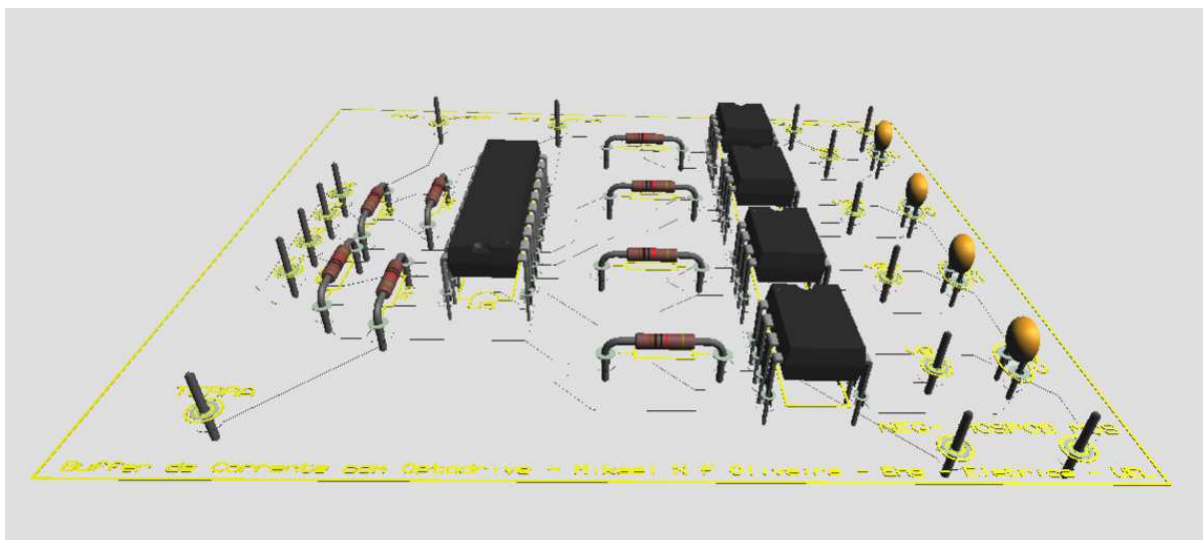
Figura A 2.3 – Perspectiva 3D da placa do buffer de corrente com optodrive .
