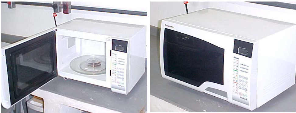
Figura 7 – Forno microondas utilizado para secagem das amostras.
