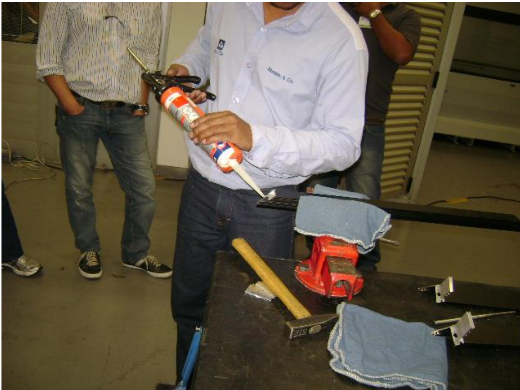
Figura 30 - Aplicação de vedante de silicone no corte do perfil
