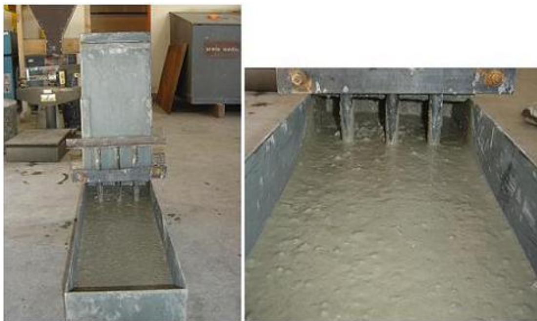
Figura 43 – Ensaio de caixa em L, verificação do nivelamento adequado, para concreto com 25% de escória de alto forno, composição 70-30% de areia natural e areia de britagem.
