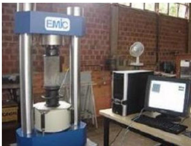
Figura 51 – Ensaio de resistência à compressão do CAA.
