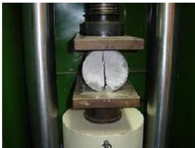
Figura 53 – Ensaio de resistência à tração do CAA, após ruptura.
