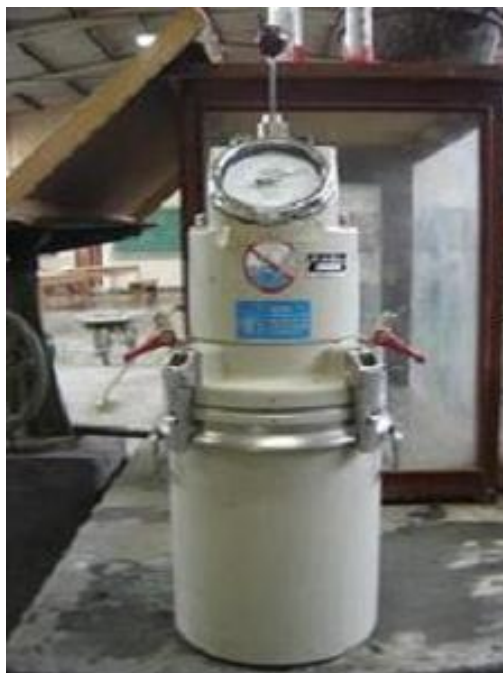
Figura 45 – Equipamento utilizado na medição do ar incorporado ao concreto.
