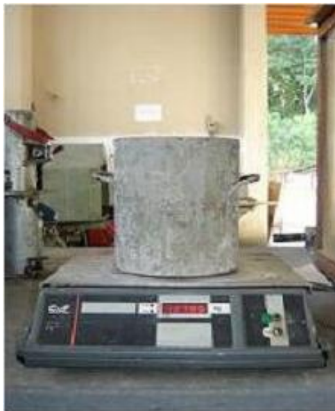
Figura 44 – Ensaio de massa específica, para o concreto com 25% de escória de alto forno, composição 70-30% de areia natural e areia de britagem.
