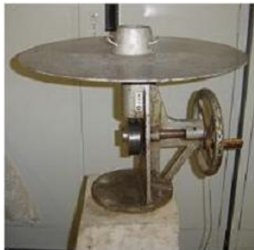
Figura 27 – Mesa de consistência, para ensaio em argamassas. O cone em questão apresenta dimensões descritas no item 2.3.2.
