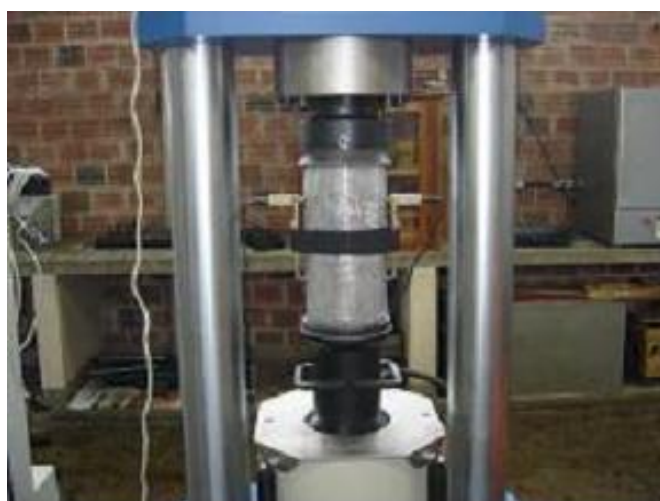
Figura 55 – Ensaio de módulo de deformação do CAA.
