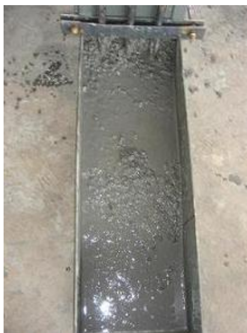
Figura 38 – Ensaio de caixa em L, verificação de exsudação e segregação do agregado graúdo, para concreto com 25% de cinza volante, combinação 30-70% de areia natural A2 e areia de britagem.
