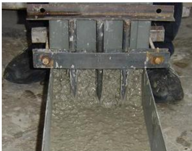
Figura 41 – Ensaio de caixa em L, verificação da retenção do agregado graúdo nas barras de armaduras, para concreto com 15% de cinza volante, composição 50-50% de areia natural e areia de britagem.
