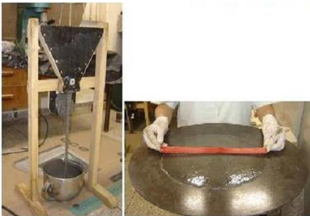
Figura 37 – Ensaios de slump flow e funil em V – argamassas com parâmetros ajustados.
