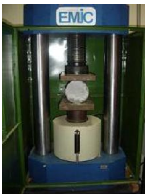
Figura 52 – Ensaio de resistência à tração do CAA.
