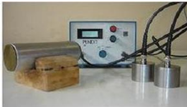
Figura 46 – Equipamento PUNDIT, utilizado na verificação da homogeneidade do CAA.
