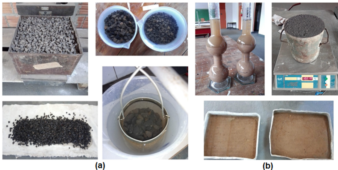
Figura 36 – Realização dos ensaios físicos. Em (a) agregado graúdo e (b) agregado miúdo
