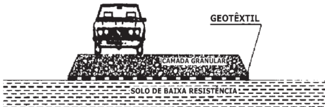
Figura 16 – Aplicação de manta geotêxtil em obra de pavimentação
