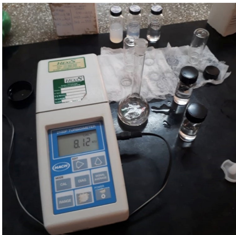
Figura 53 – Turbidímetro utilizado e procedimento de ensaio da turbidez
