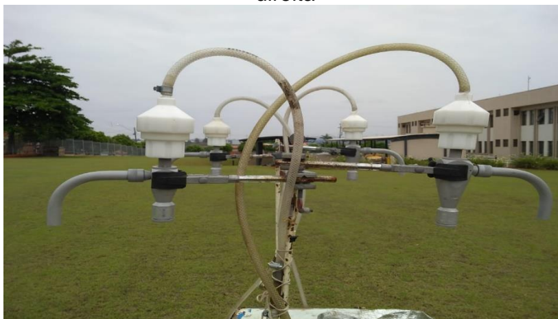
Figura 12 – Ciclones com os filtros de \text{MP}_{2,5} e \text{MP}_1 , Fórum de Justiça Ibiporã/PR à direita
