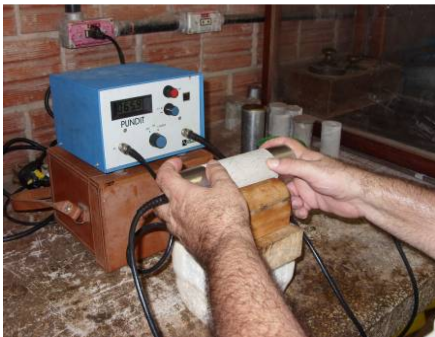
Figura 20 – Ensaio para a determinação do módulo de elasticidade dinâmico.
