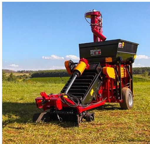
Figura 4.2 - Recolhedora de café mecânica marca Bertanha modelo Mogiana (Pé de Boi) para recolhimento, abanação e transporte.
