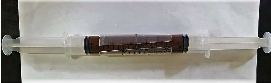
Figura 3.5: Conjunto de seringas acopladas contendo amostra de sedimento referente ao experimento de difusão.
