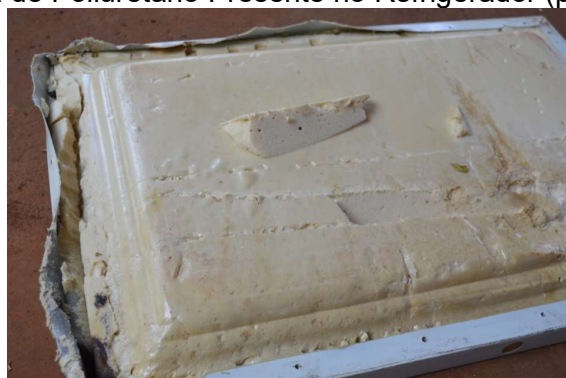
Figura 3 - Espuma de Poliuretano Presente no Refrigerador (porta do congelador)
