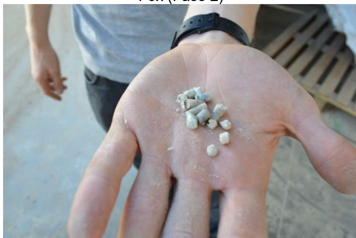
Figura 19 – Amostra do Pellet de PU Produzido como Resultado Final na Indústria Fox (Fase 2)
