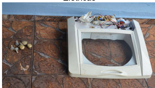
Figura 13 – Retirada da Tampa Superior da Máquina de Lavar e de suas Partes Elétricas
