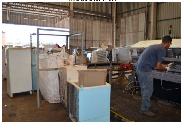
Figura 16 – Remoção de Óleo e Gás Presentes nos Refrigeradores (Fase 1) – Indústria Fox
