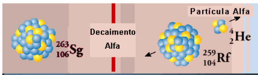
Figura 2 – Decaimento alfa. (Adaptado de http://www.lbl.gov/abcAvallcharf )
