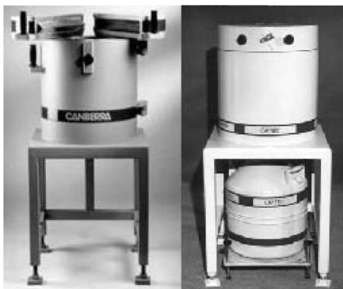
Figura 31 – Blindagens da Canberra (Modelo 747) e da Ortec (HPLBS1) com o dewar do detector.
