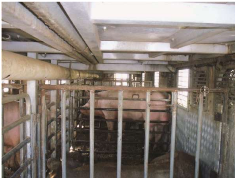
Figura 42- Veículo climatizado. Tubulação para ar frio, exaustores, aberturas laterais.
