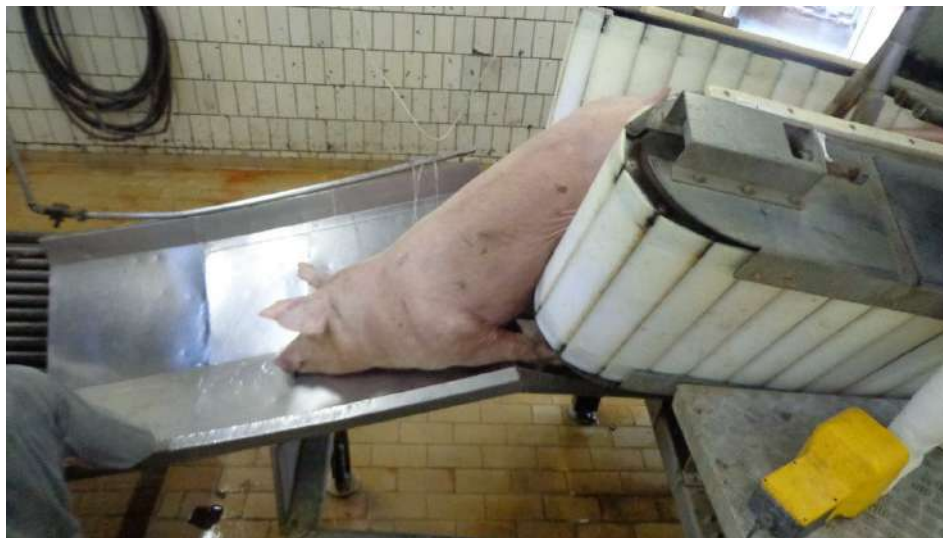
Figura 44- Suíno na etapa entre insensibilização por eletrocussão e sangria. Nesta etapa deve ser conferida a eficiência da insensibilização.
