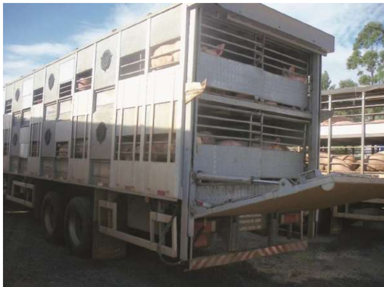
Figura 41- Veículo com teto adequado para viagens longas.
