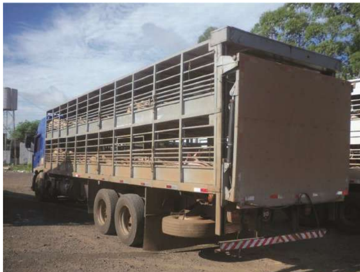
Figura 37- Caminhão para transporte de suínos. Exemplo de veículo adequado ao transporte.
