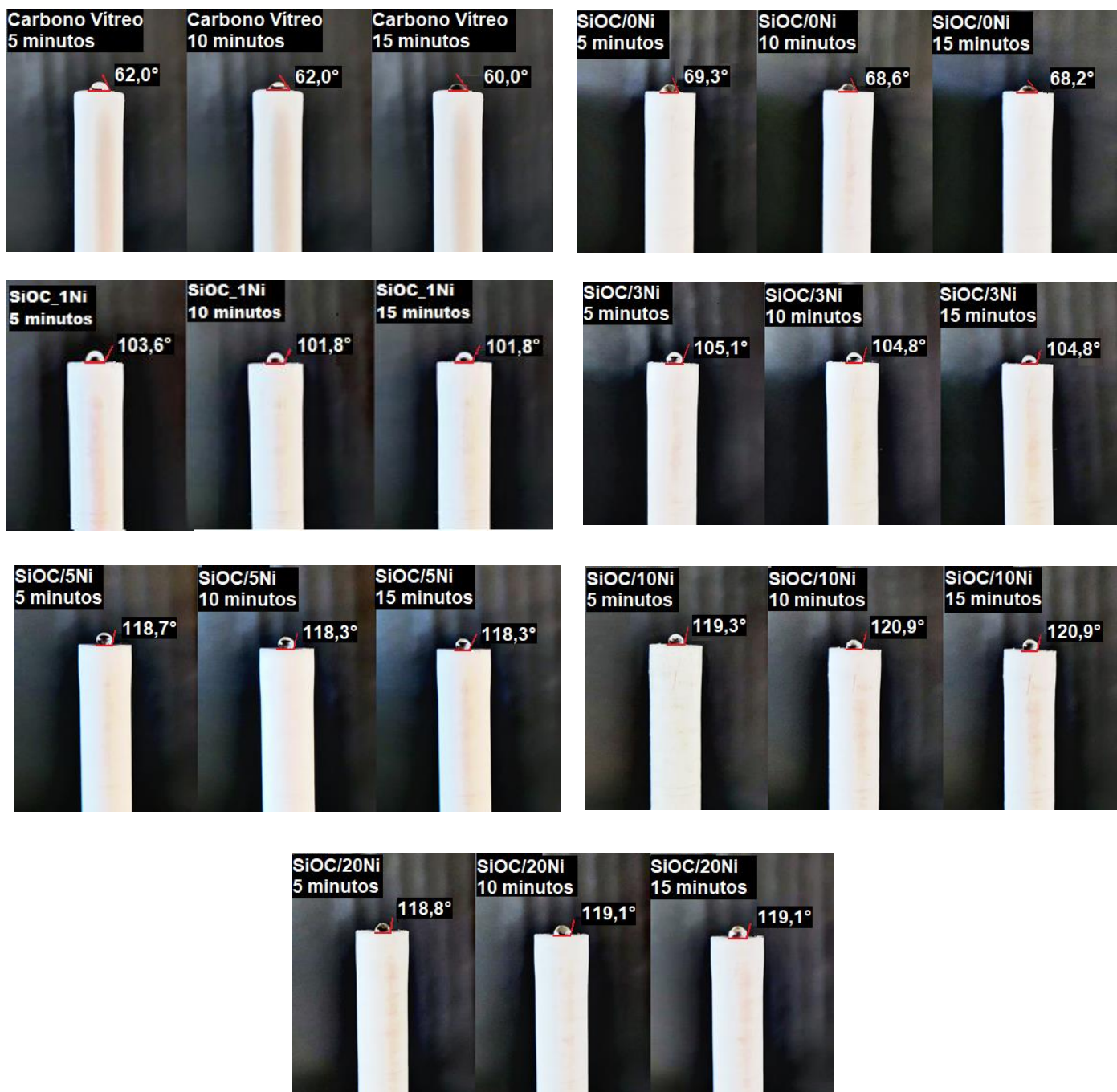
Figura 34 – Ângulo de contato do eletrodo de carbono vítreo e eletrodos de pasta dos materiais cerâmicos de oxycarbeto de silício com diferentes quantidades de níquel (SiOC/XNi) durante os períodos de tempos de 5, 10 e 15 minutos.
