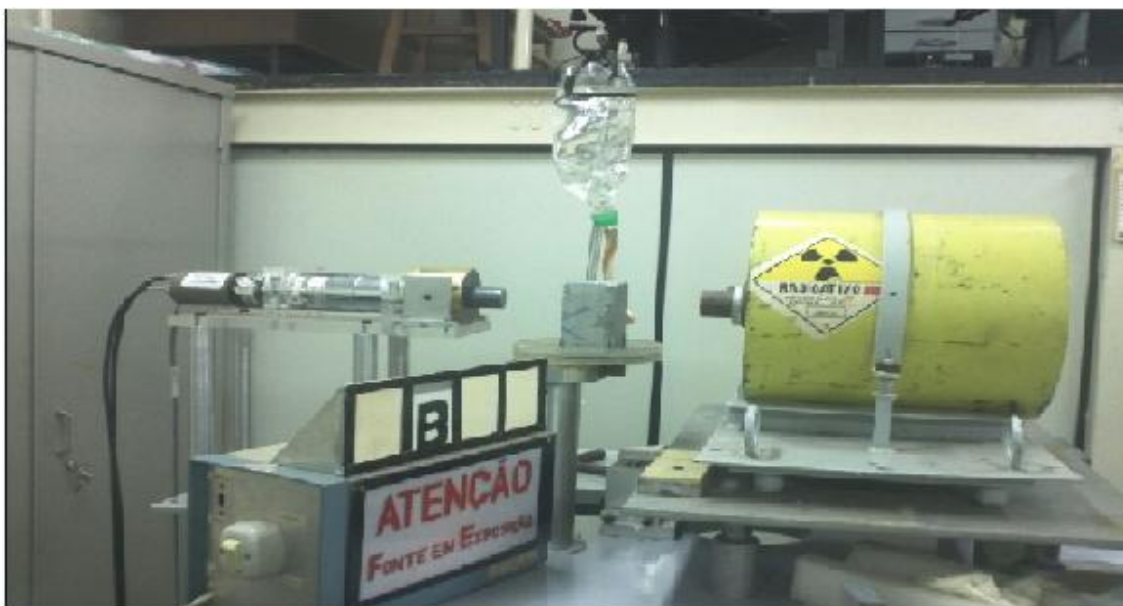
Figura15: Foto do arranjo experimental aplicado para a análise da frente de molhamento.
