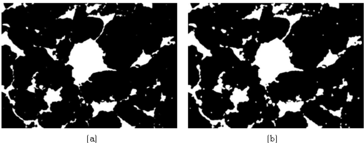
Figura 139 – Aplicação da operação de dilatação em uma imagem binarizada do arenito da formação Tumblagooda (branco é o poro e preto o sólido). (a) imagem oriunda da operação de erosão da Figura 137b; (b) imagem com aplicação da operação de dilatação.
