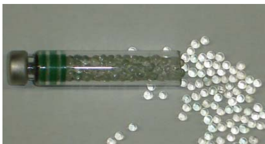
Figura 52 – Tubo de vidro contendo esferas de vidro com 600 \mu\text{m} de diâmetro.
