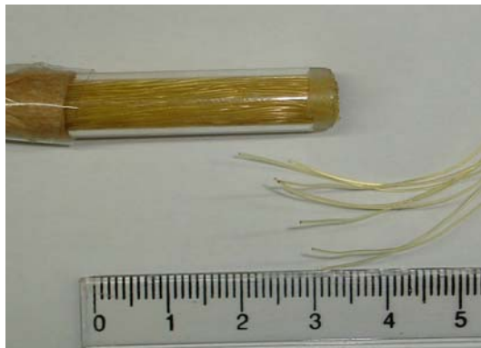
Figura 54 – Tubo de vidro contendo linhas de nylon com 355 \pm 8 \mu\text{m} de diâmetro.
