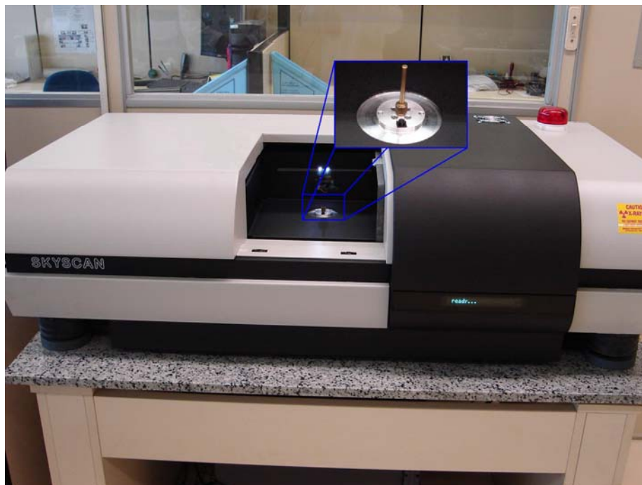
Figura 37 – Microtomógrafo da SkyScan modelo 1172, com detalhe do porta amostras.
