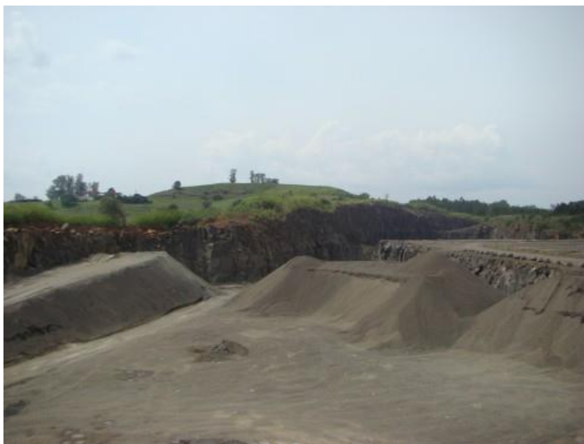
Figura 7 – Depósito a céu aberto de resíduo de moagem de basalto
