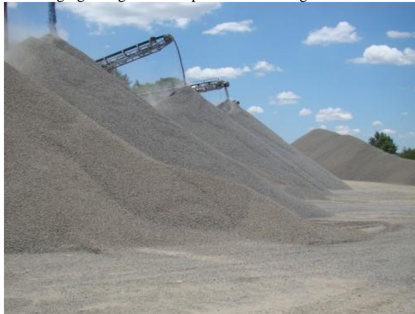
Figura 5 - Montes de agregados gerados no processo da britagem do basalto
