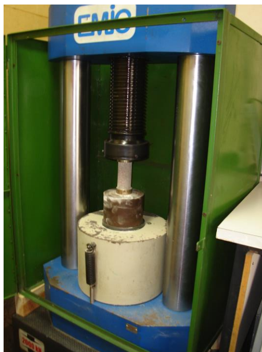
Figura 44 – Ruptura do corpo de prova na prensa mecânica
