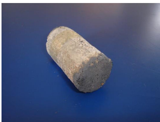
Figura 24 – Corpo de prova com pasta de prata dissipadora de calor aplicada no topo e na base
