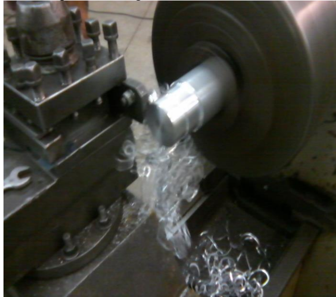
Figura 10 - Processo de usinagem do tarugo de alumínio no torno mecânico
