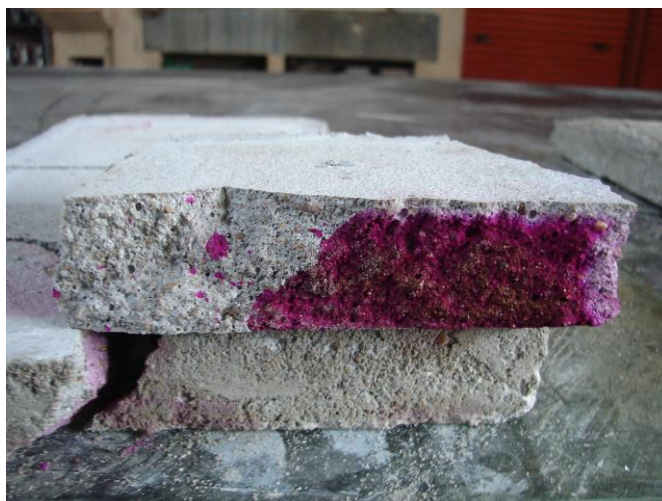
Figura 47– Placa de REF-A rompida com aplicação de fenolftaleína para verificar a carbonatação
