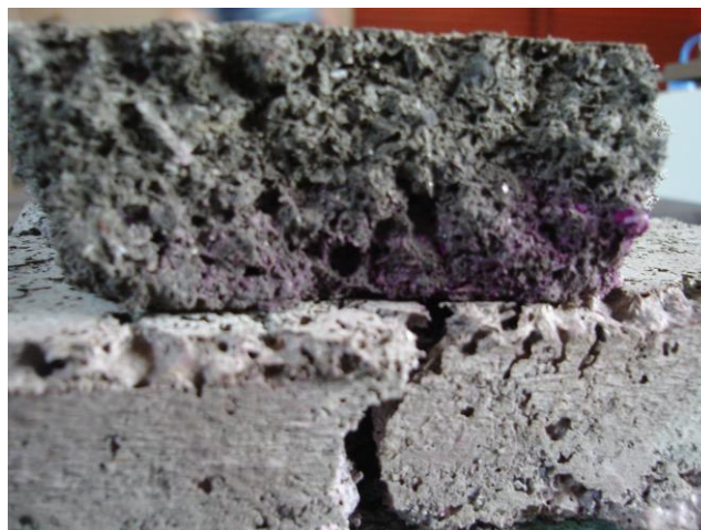
Figura 48– Placa de ARB rompida com aplicação de fenolftaleína para verificar a carbonatação
