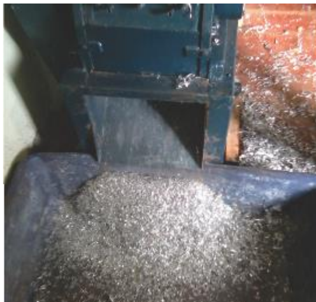
Figura 11 - Produção de partículas de alumínio no moinho de facas alternadas
