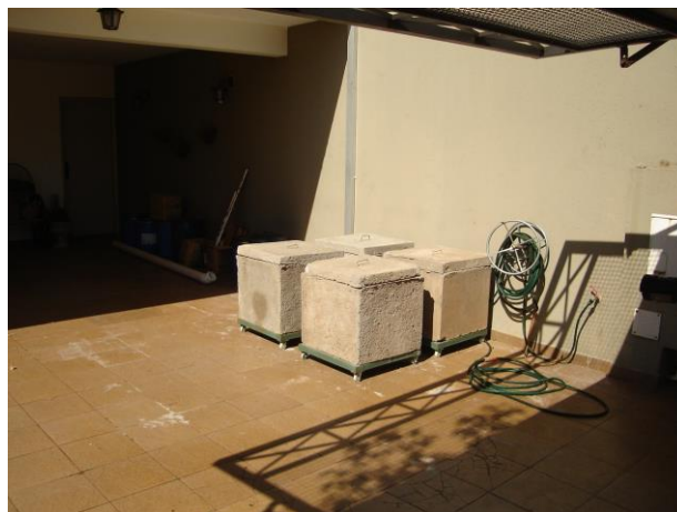
Figura 55– Protótipos das argamassas REF-A, ARN, ARB e ARA sobre os suportes metálicos com rodízio
