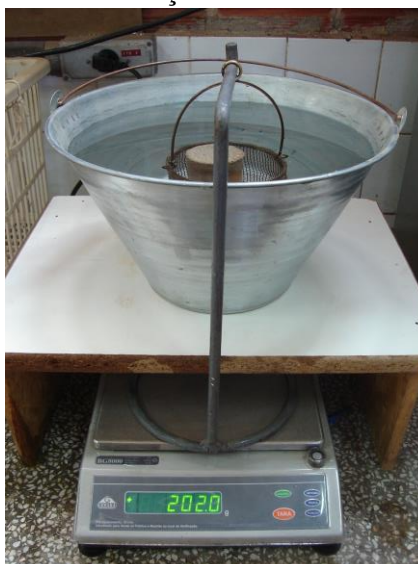
Figura 40 – Verificação da massa em balança hidrostática
