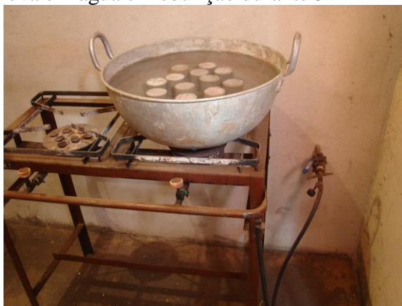
Figura 38 – Corpos de prova em água em ebulição durante 5h
