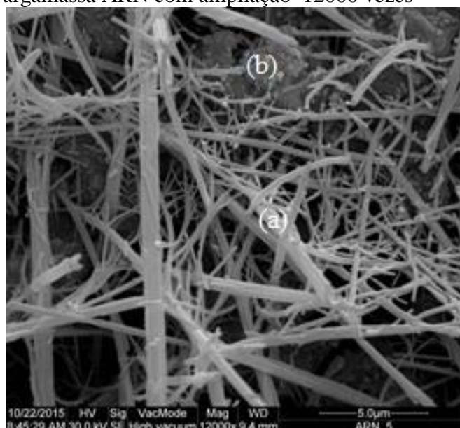
Figura 69 – Imagem argamassa ARN com ampliação 12000 vezes
