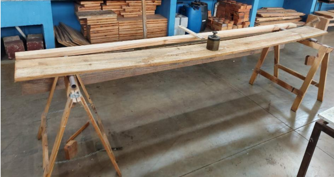
Figura 33 - Ensaio de Flexão Estático a 3 pontos
