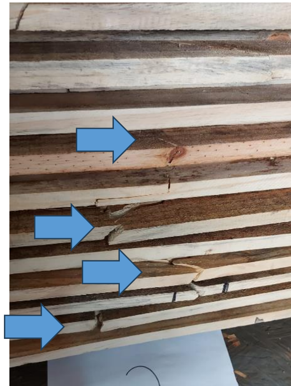
Figura 62 - Rupturas lâminas CP2 – Detalhe
