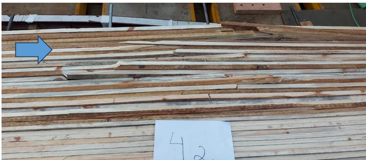
Figura 68 - Rupturas lâminas CP4 – Detalhe
