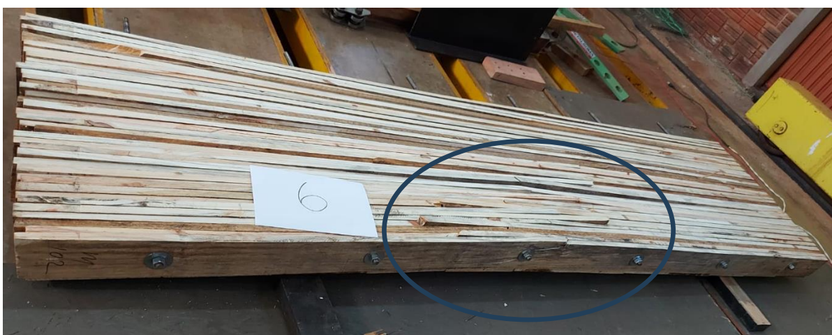
Figura 73 - Rupturas lâminas CP6
