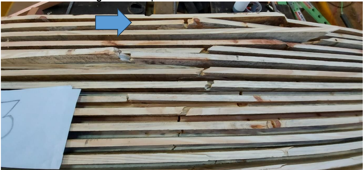
Figura 65 - Rupturas lâminas CP3 - Detalhe
