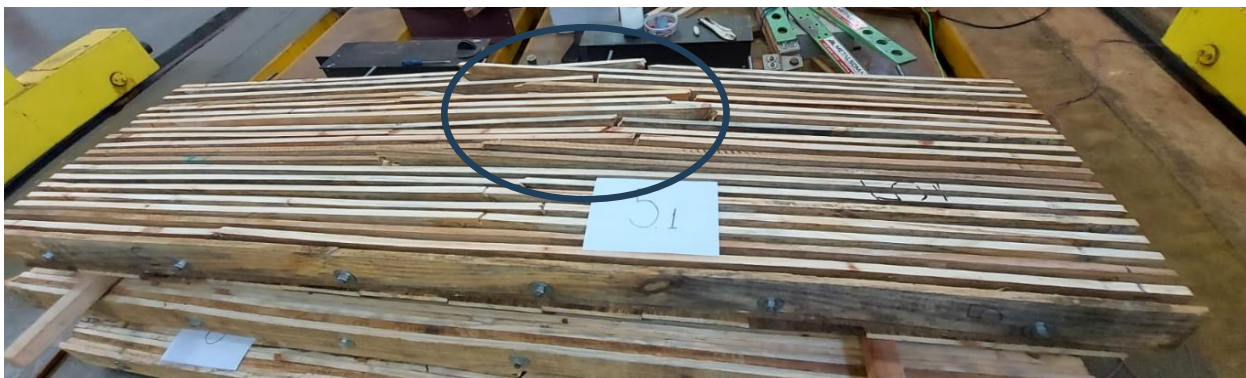
Figura 70 - Rupturas lâminas CP5
