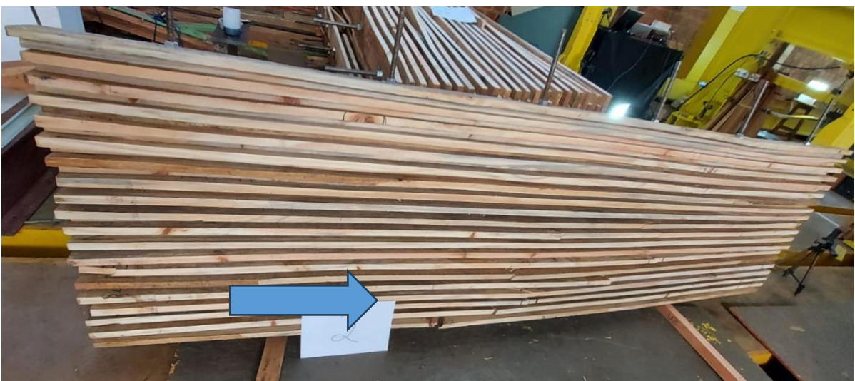
Figura 61 - Rupturas lâminas CP2
