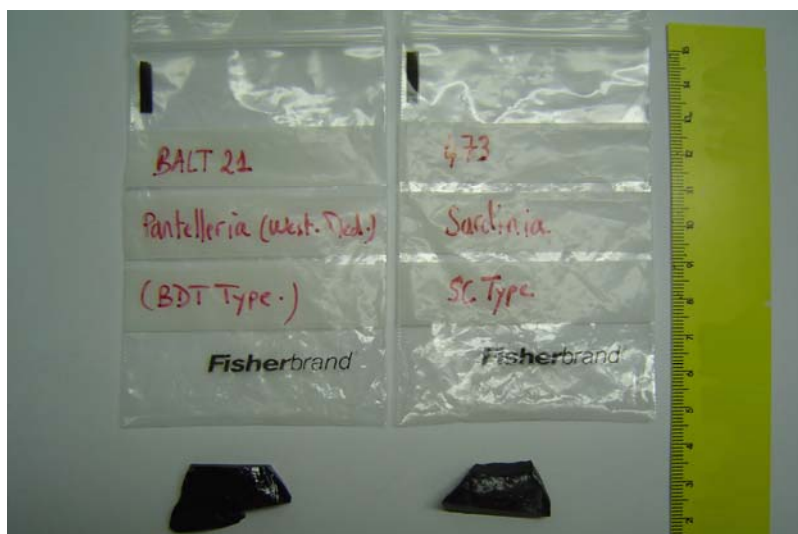
Figura 34 – Amostras de obsidianas da região de Pantelleria e Sardenha, na Itália, analisadas pelos equipamentos portáteis de Fluorescência de Raios X, PXRF-LFNA-02 e PXRF-LFNA-03.
