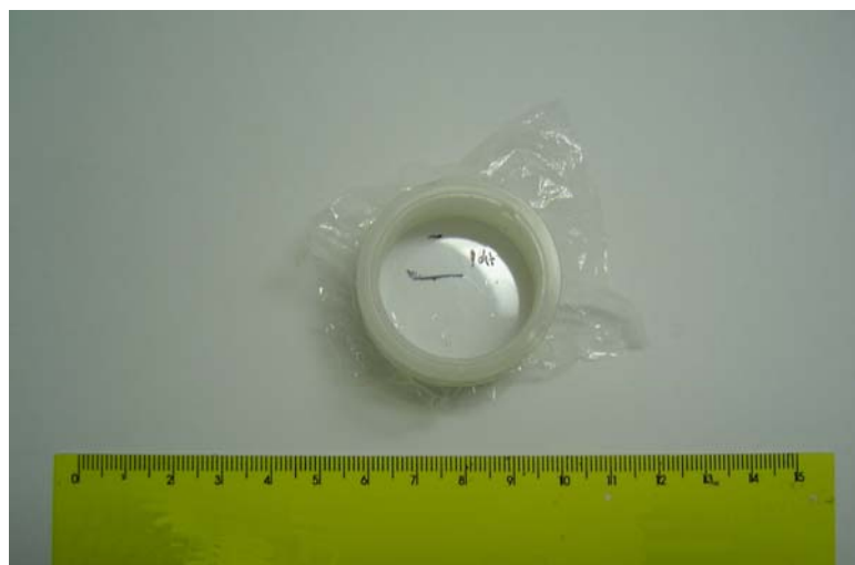
Figura 33 – Vista superior do porta amostra utilizado nas medidas das amostras de obsidianas.
