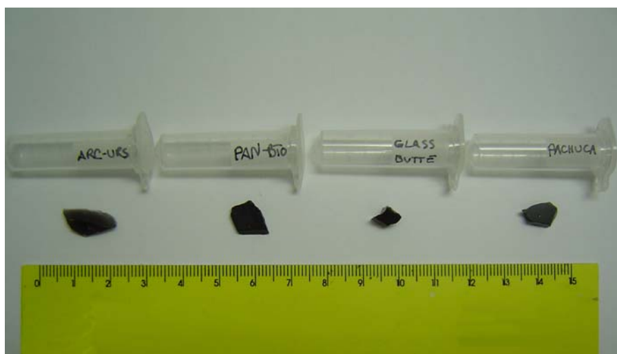
Figura 38 – Amostras de obsidianas certificadas analisadas pelos equipamentos portáteis de Fluorescência de Raios X, PXRF-LFNA-02 e PXRF-LFNA-03.
