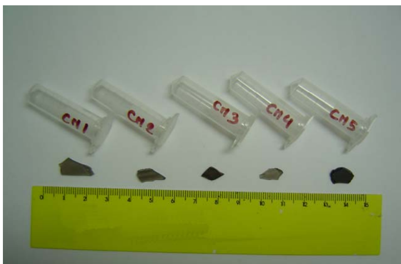
Figura 29 – Amostras de obsidianas da região de Mullumica no Equador analisadas pelos equipamentos portáteis de Fluorescência de Raios X, PXRF-LFNA-02 e PXRF-LFNA-03.
