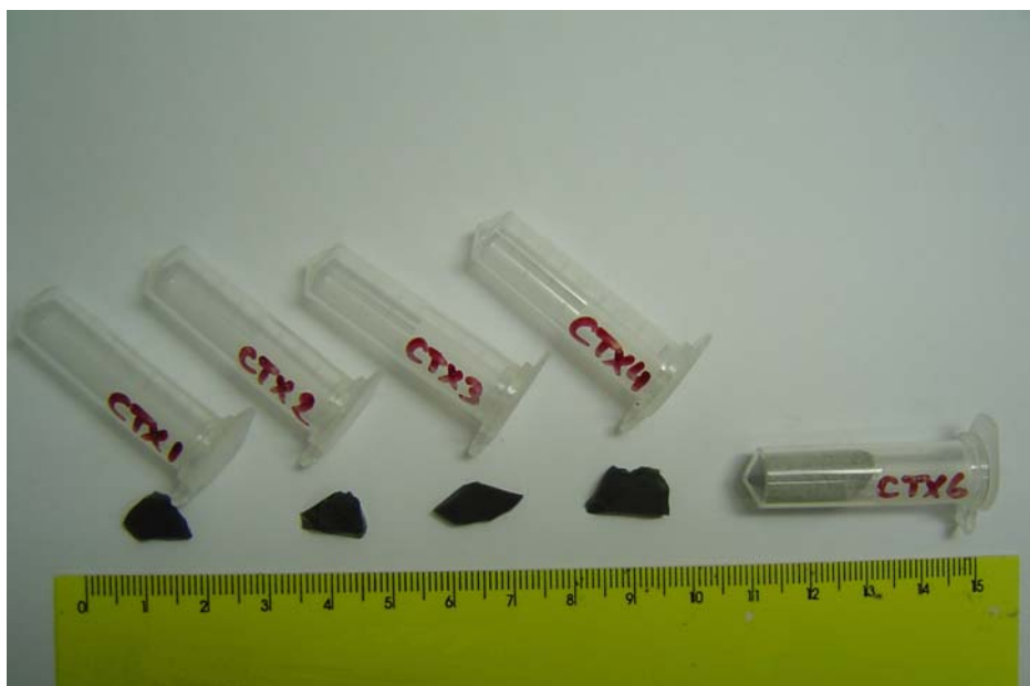
Figura 31 – Amostras de obsidianas da região de Cotopaxi, no Equador, analisadas pelos equipamentos portáteis de Fluorescência de Raios X, PXRF-LFNA-02 e PXRF-LFNA-03 (a mostra CTX6 não foi analisada).
