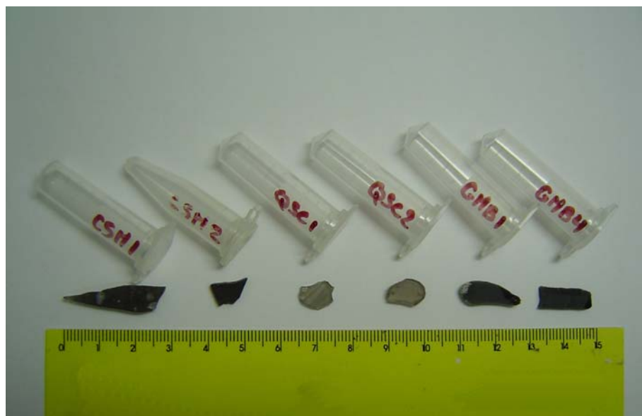
Figura 30 – Amostras de obsidianas das regiões de Mullumica, Quiscatola e Rio Guambi, no Equador, analisadas pelos equipamentos portáteis de Fluorescência de Raios X, PXRF-LFNA-02 e PXRF-LFNA-03.
