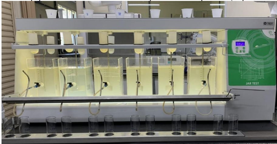
Figura 16 – Equipamento Jarsteste durante a realização dos ensaios por CFS (etapa de floculação)
