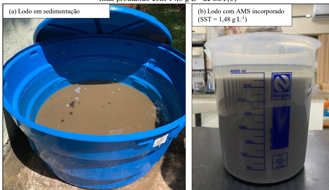
Figura 46 – Produção de lodo com AMS incorporado: etapa de sedimentação em escala piloto adaptada(a) e lodo final produzido com 14,8 \text{g L}^{-1} de SST(b)
