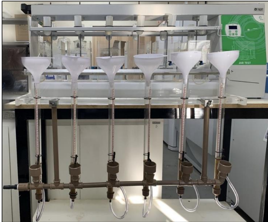
Figura 18 - Equipamento Jarteste e sistema de filtros de laboratório de areia – FLAs
