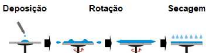
Figura 3.1 – Representação da técnica de spin-coating (Laurell Technologies Inc., 2019).
