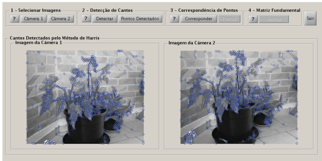
Figura 3.9: Execução da Detecção de Cantos das Imagens PLANTA
