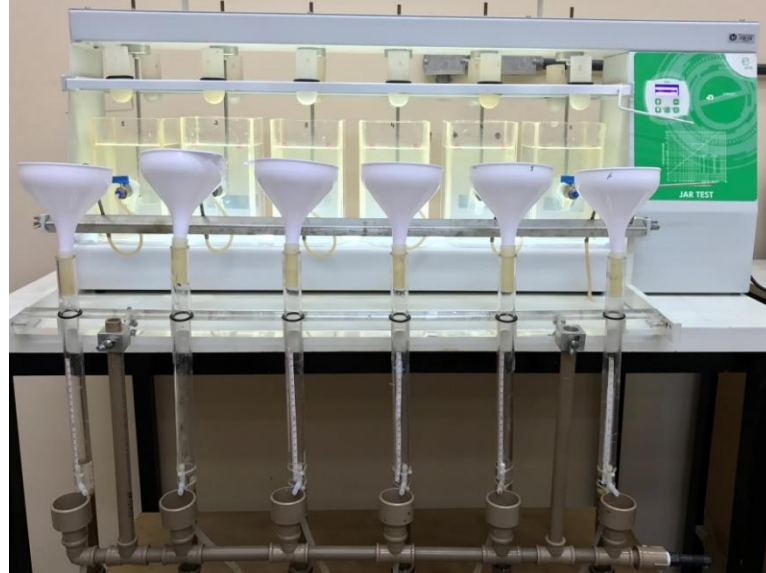
Figura 19 – Equipamento Jarteste e sistema de filtros de laboratório de areia – FLAs
