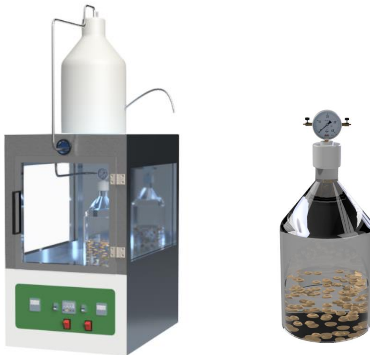
Figura 5- Esquema do reator acidogênico – a) Sistema de incubação; b) Reator acidogênico.
