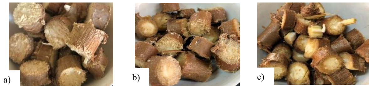
Figura 4 - Rama de mandioca: a) in natura; b) após a hidrólise ácida; c) após a hidrólise a vapor.
