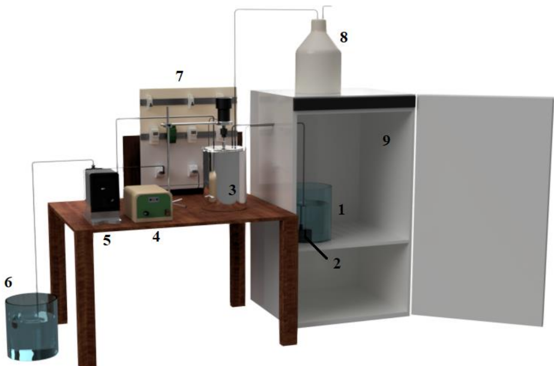
Figura 6 - Sistema metanogênico: 1. Reservatório do afluente; 2. Bomba de alimentação; 3. AnSBBR; 4. Sistema de agitação; 5. Bomba de descarga; 6. Reservatório do efluente; 7. Painel de controle para acionamento automático das bombas e do sistema de agitação; 8. Gasômetro; 9. Refrigerador.
