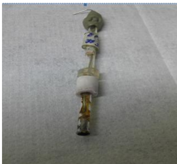
Figura 1.2. Eletrodo modificado com CNT/hemina/Nujol®. (A = 0,205 cm 2 )
