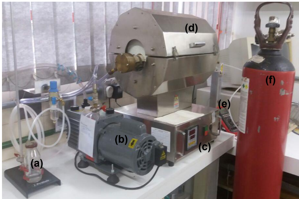
Figura 6 - Forno e acessórios utilizados para o tratamento térmico dos pós dos catodos (a) borbulhador, (b) bomba de vácuo mecânica, (c) programador da temperatura do forno, (d) forno tubular, (e) termopar e (f) cilindro de O 2
