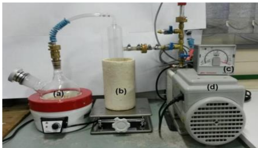
Figura 4 - Sistema para extração do eletrólito a vácuo: (a) balão de fundo redondo, (b) condensador, (c) barômetro e (d) bomba de vácuo mecânica
