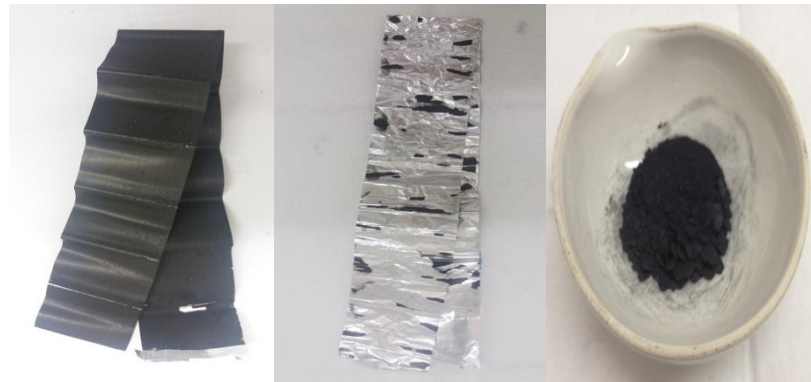
Figura 13 - (a) Catodo de \text{LiCoO}_2 de uma BIL descartada antes da extração do pó (material eletroativo), (b) fita de alumínio após a extração do material eletroativo e (c) pó extraído do catodo
