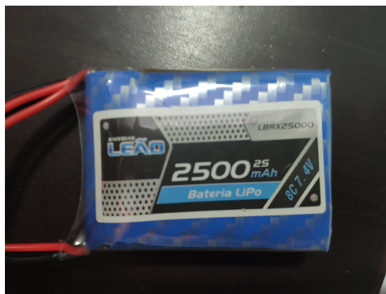
Figura 4.3: Bateria LiPo de 7,4 V e 2500 mAh.
