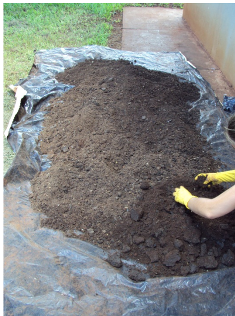
Figura 4 – Secagem do lodo de esgoto coletado na lagoa de estabilização da Estação de Tratamento de Esgoto do Serviço Autônomo de Água e Esgoto (SAAE), Bandeirantes-PR.
