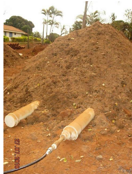
Figura 3 – Aeração forçada por injeção de ar com uso de compressor.
