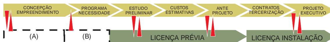
Figura 22 - Relação entre as etapas do processo de projeto e do licenciamento ambiental evidenciada neste estudo
