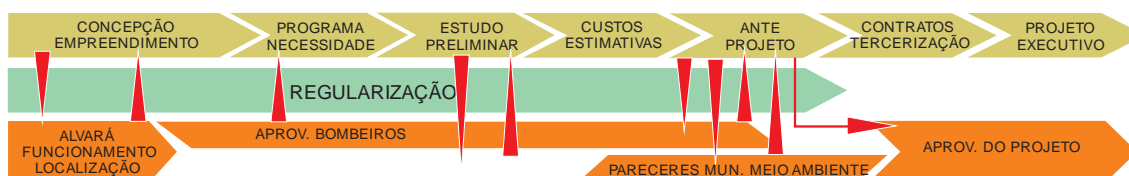
Figura 20 - Relação entre as etapas do processo de projeto e as do processo de regularização
