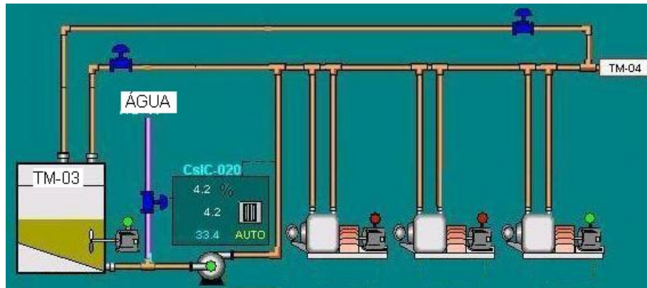
Figura 4.30 – Diagrama esquemático do processo de consistência
