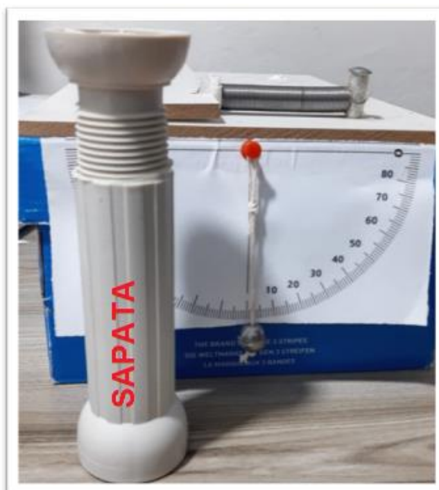
Figura 28: Sapata ajustada com ângulo de 20°(graus).
