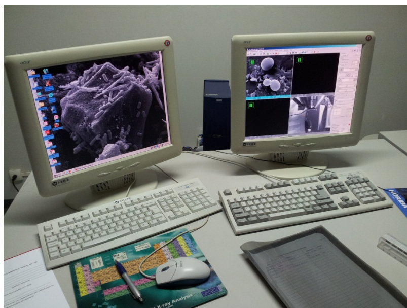
Figura 4.6 – Equipamento para análise de espectroscopia de energia dispersiva (EDS-OXFORD), software INCA, acoplado ao MEV – FEI Quanta 200.
