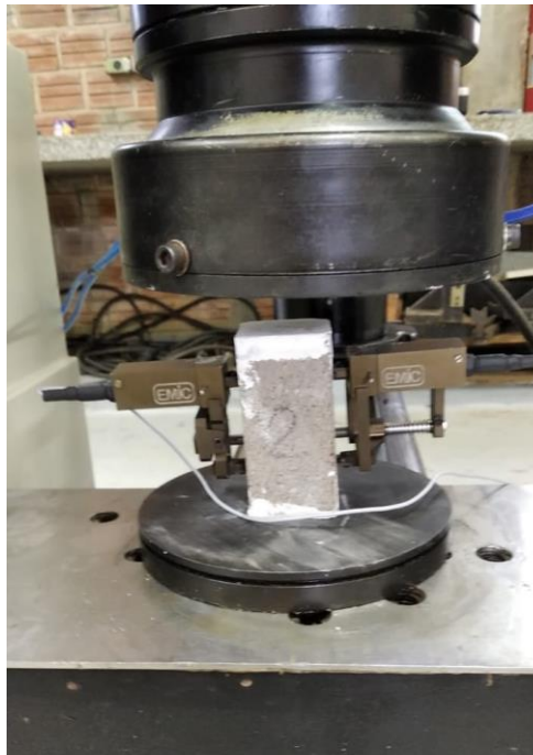
Figura 28 – Detalhe do ensaio com extensômetro
