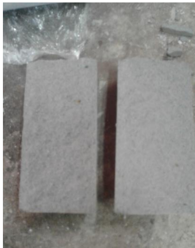
Figura 45 – Detalhe da ruptura do corpo de prova de argamassa
