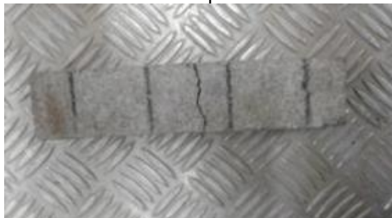
Figura 43 – Detalhe da linha de ruptura do ensaio dos testemunhos
