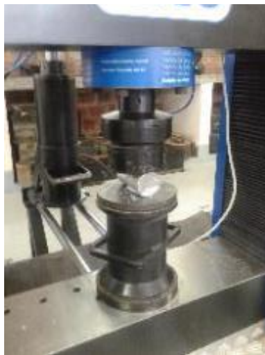
Figura 24 – Ensaio de tração nos corpos de prova de argamassa
