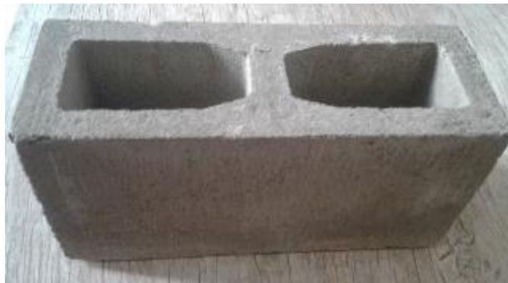
Figura 8 – Bloco de concreto 14x19x39 utilizado no experimento
