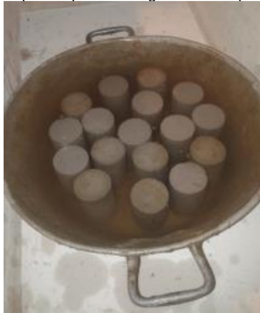
Figura 22 – Corpos de prova de argamassa em processo de cura
