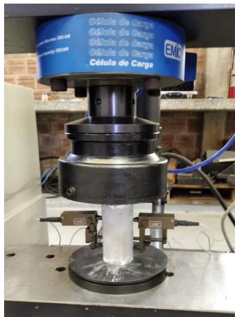
Figura 31 – Detalhe do ensaio com extensômetro no corpo de prova de argamassa
