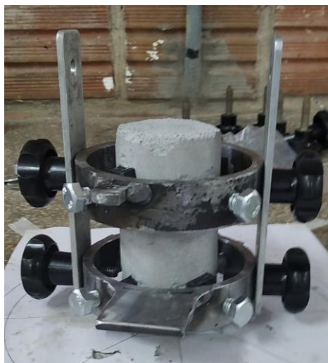
Figura 30 – Detalhe da fixação dos anéis no corpo de prova de argamassa
