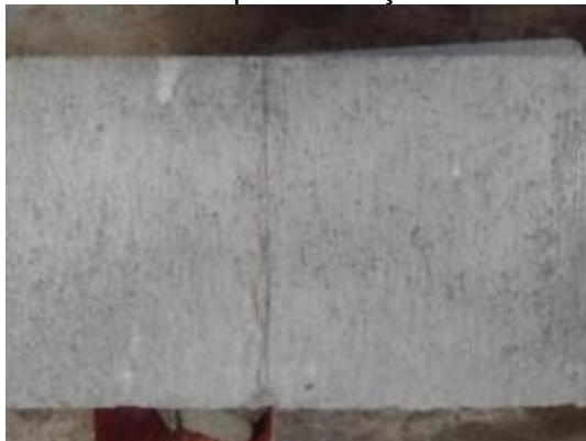
Figura 41 – Detalhe da ruptura a tração no bloco de concreto
