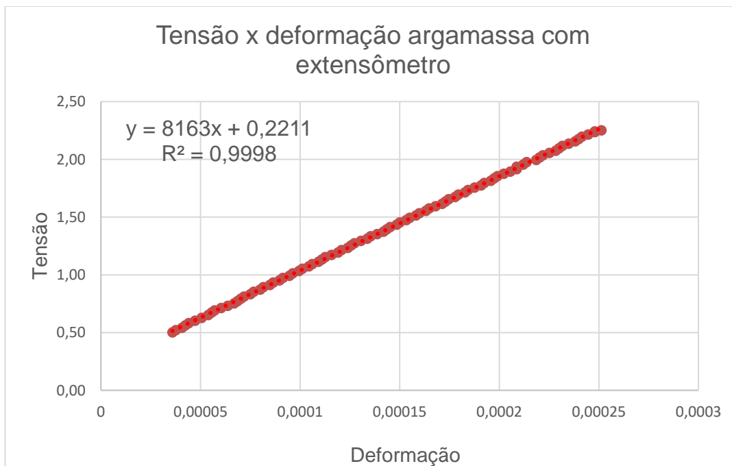
Figura 49 – Gráfico tensão x deformação CP 2 de argamassa através do extensômetro
