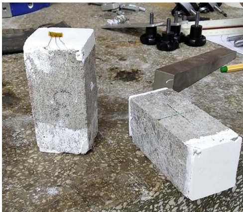
Figura 25 – Detalhe do capeamento dos testemunhos
