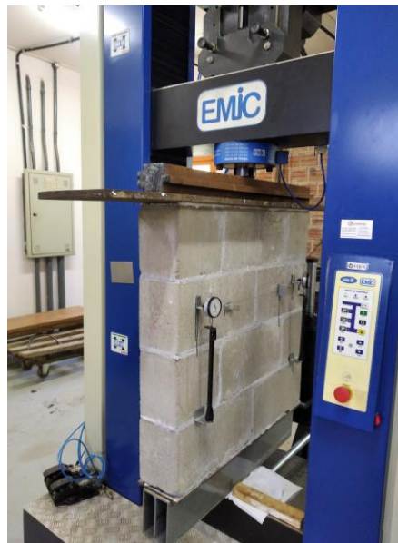
Figura 36 – Detalhe da mini-parede com os relógios comparadores
