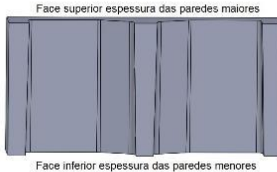
Figura 11 – Seção longitudinal do bloco
