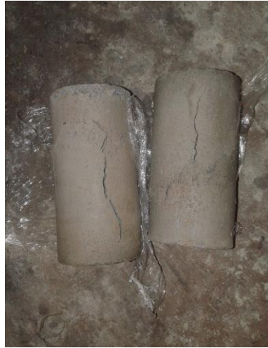
Figura 44 – Detalhe da ruptura do ensaio de compressão da argamassa
