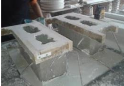
Figura 12 – Capeamento dos blocos de concreto
