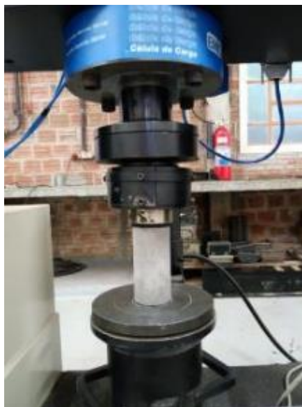
Figura 23 – Ensaio de compressão nos corpos de prova de argamassa
