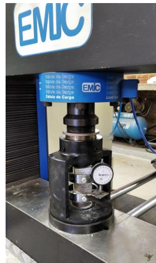
Figura 26 – Detalhe do ensaio do testemunho
