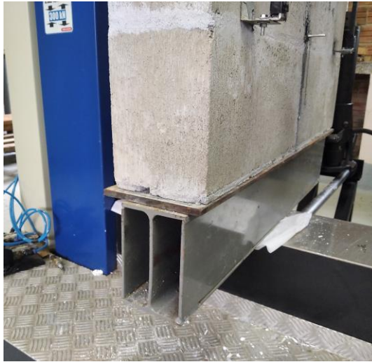
Figura 35 – Detalhe do apoio na face inferior da mini-parede na máquina universal de ensaio
