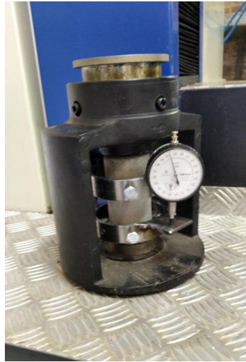
Figura 29 – Ensaio corpo de prova de argamassa
