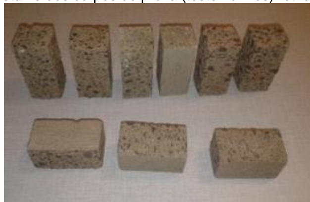
Figura 17 – Detalhe dos corpos de prova (testemunhos) retirados dos blocos
