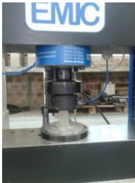
Figura 18 – Ensaio de compressão dos testemunhos
