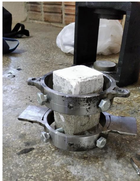
Figura 27 – Detalhe dos anéis no testemunho
