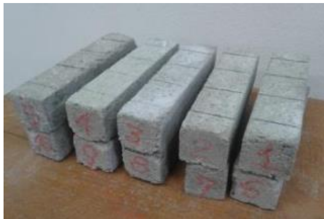
Figura 19 – Testemunhos para ensaio a tração
