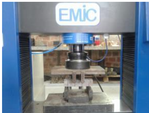
Figura 20 – Ensaio à tração na flexão dos testemunhos
