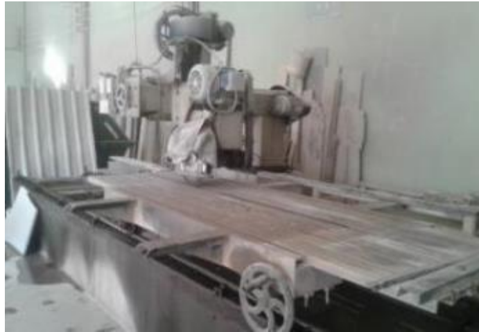
Figura 15 – Máquina de corte de mármore e granitos
