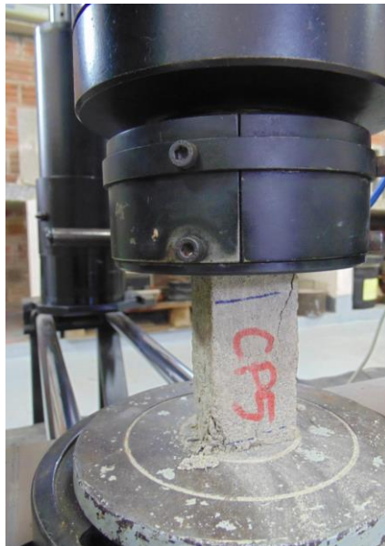
Figura 42 – Detalhe da ruptura do ensaio à compressão no testemunho
