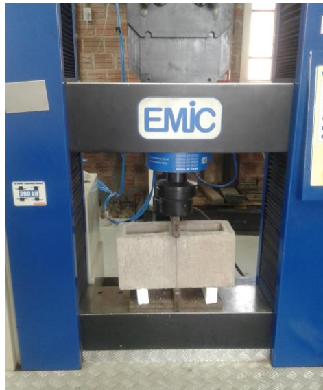
Figura 14 – Detalhe do ensaio à tração na flexão no bloco de concreto
