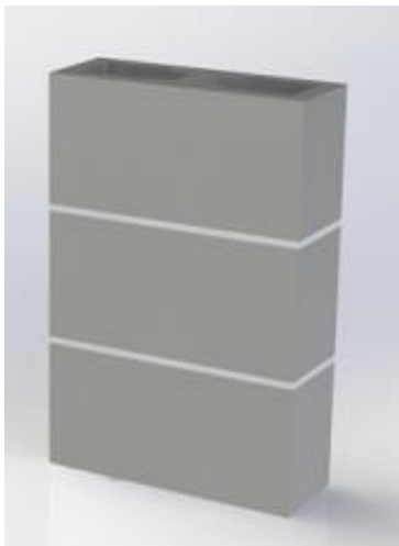
Figura 5a – Prisma sem junta vertical
