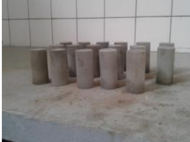
Figura 21 – Corpos de prova de argamassa moldados
