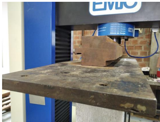
Figura 34 – Detalhe do apoio na face superior da mini-parede na máquina universal de ensaio
