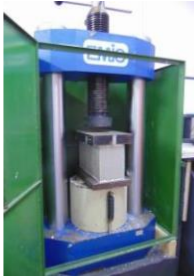
Figura 13 – Prensa Hidráulica utilizada nos ensaios dos blocos.
