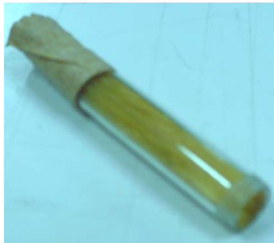
Figura 35. Amostra de Linhas de nylon, inseridas em um tubo de vidro, elaborada para validação da microtomografia de raios X.
