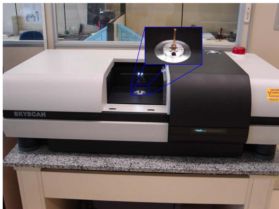
Figura 32. Microtomógrafo SkyScan, modelo 1172, com detalhe do movimentador de amostra.
