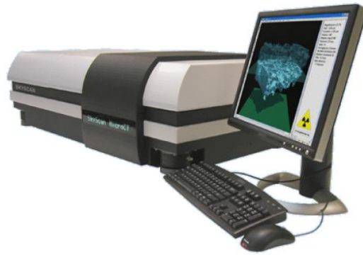
Figura 31. Microtomógrafo SkyScan modelo 1172 juntamente com um computador para manipular as projeções obtidas (INSTRUCTION MANUAL SKYSCAN, 2005).
