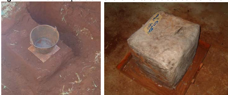
Figura 4.7 – Confecção e armazenamento do bloco 30X30X30 cm.
