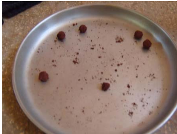
Figura 5.2 – Torrão de solo talhado de uma amostra indeformada para a realização do Crumb Test .
