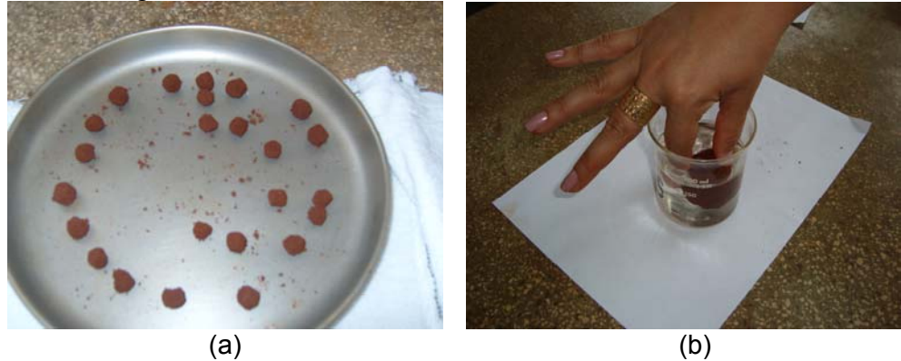
Figura 4.9 – (a) Torrão de solo talhado de uma amostra indeformada para a realização do crumb test . (b) e sendo colocado em um béquer contendo água destilada
