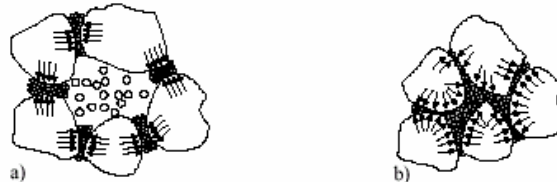
Figura 2.1 – Estrutura do solo carregado: a) antes da inundação; b) após a inundação.
