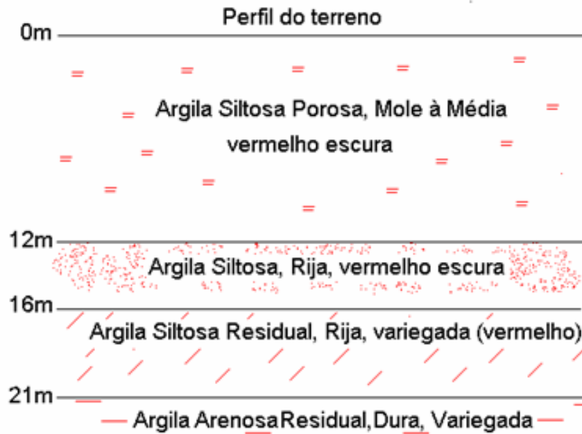
Figura 3.2 – Perfil de solo característico do CEEG/UEL.
