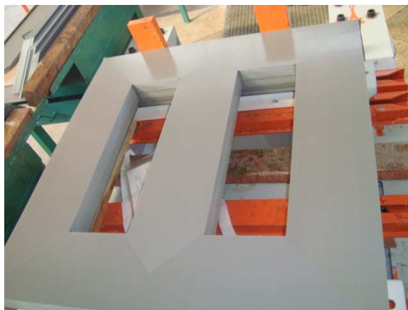
Figura 4.8: Montagem do núcleo Single Step-Lap sem a furação nas chapas.
