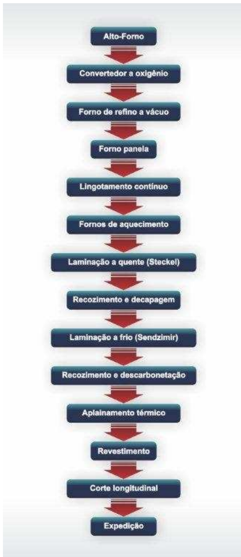
Figura A.1: Fluxo de produção das ligas de aço-silício de grão orientado.
