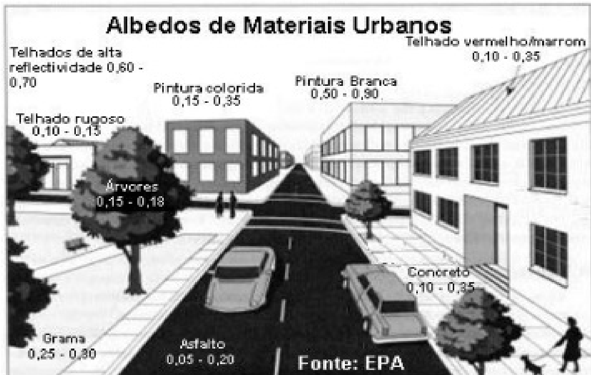
Figura 06 - Albedos de materiais urbanos
