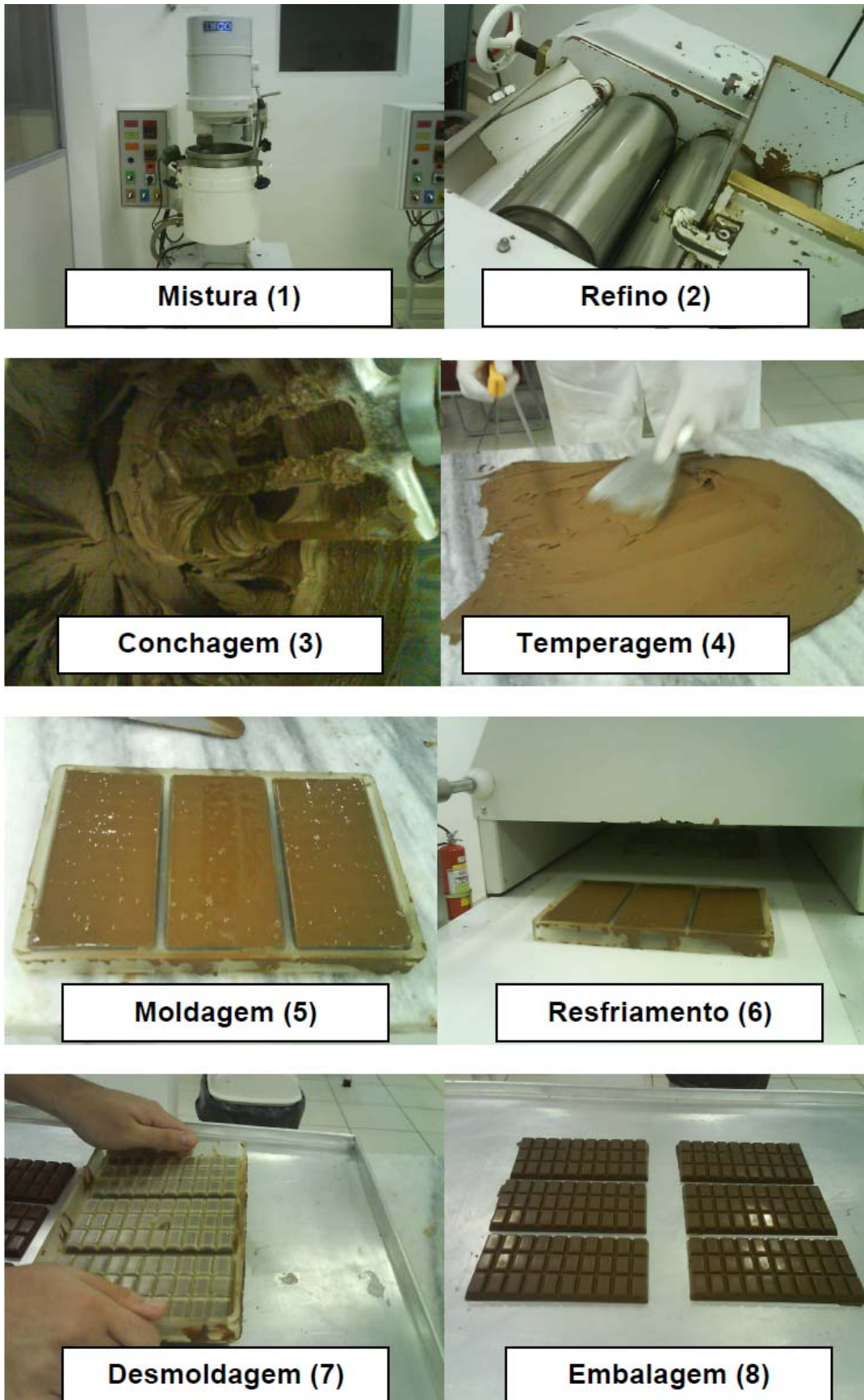
Figura 17 – Etapas do processamento do chocolate da esquerda para direita, de cima para baixo em ordem numérica.
