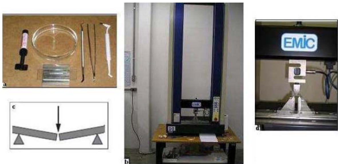
Figura 39. – a) Utensílios para a elaboração do espécime; b) Máquina universal para ensaios mecânicos.; c) amostra com fratura; d) Ponteira da Máquina para a análise de resistência Flexural.
