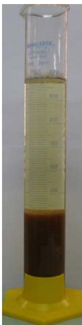
Figura 5.15: Lodo do ensaio 30 do processo coagulação–floculação–sedimentação utilizando PAC como coagulante, após 30 horas de sedimentação.
