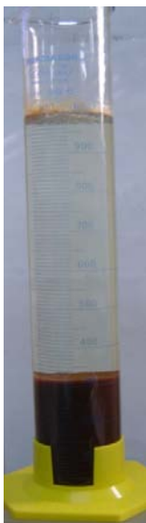
Figura 5.20: Lodo do ensaio 12 do processo de coagulação-floculação-sedimentação utilizando cloreto férrico como coagulante, após 24 horas de sedimentação
