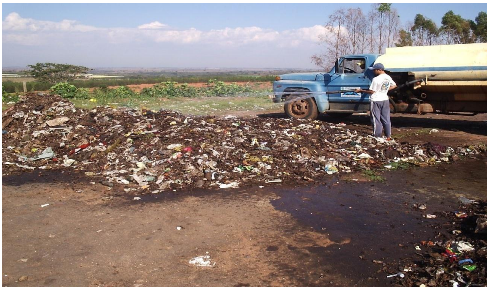
Figura 24 – Adição de água na leira com o auxílio de caminhão-pipa
