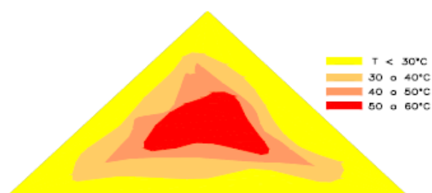
Figura 9 – Perfil típico de temperatura em uma leira Fonte: Russo (2003)
