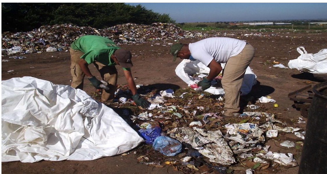
Figura 21 – Associados da ACAMART auxiliando na separação dos diferentes tipos de materiais para realização da análise gravimétrica da massa de resíduo
