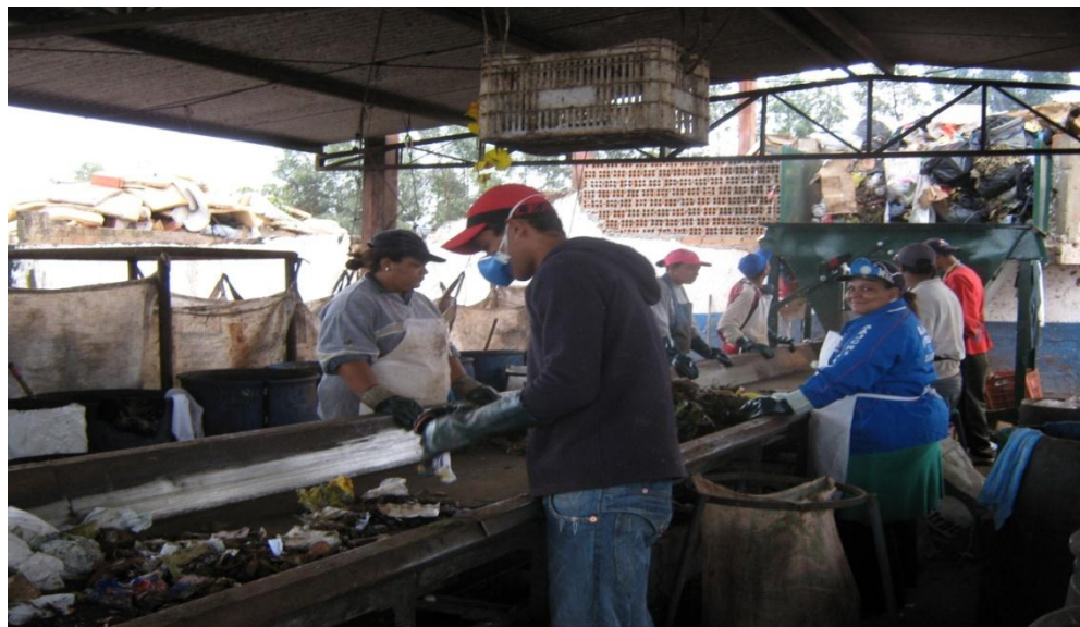
Figura 17 – Moega (ao fundo) e esteira de catação da Central de Triagem e compostagem de Martinópolis/SP
