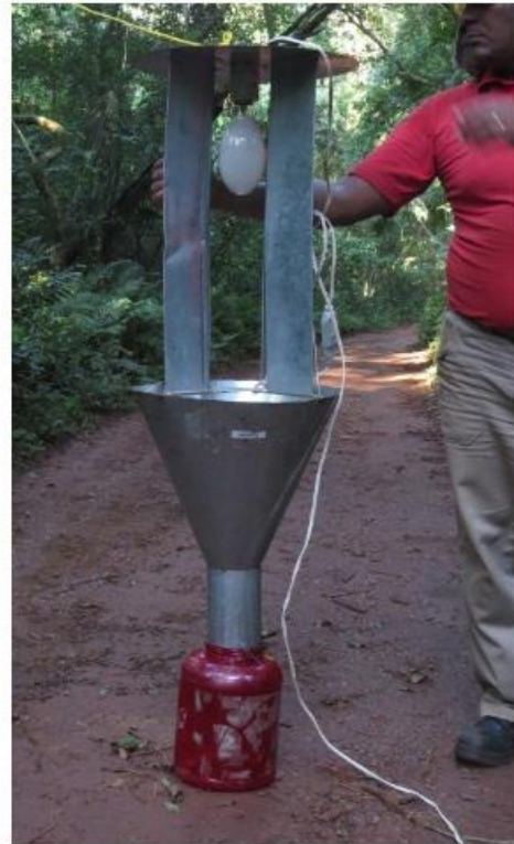
Figura 3: Armadilha modelo Luiz de Queiroz adaptada, utilizada para a coleta de Curculionidae, no Parque Estadual Mata dos Godoy - PR.
