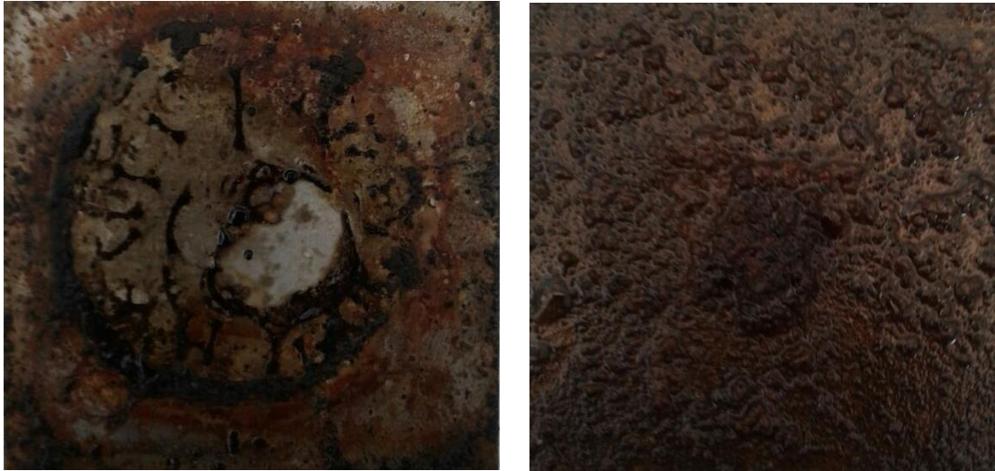
Figura 4. Liga de aço carbono em contato com extrato de amora e biodiesel ao final das análises
