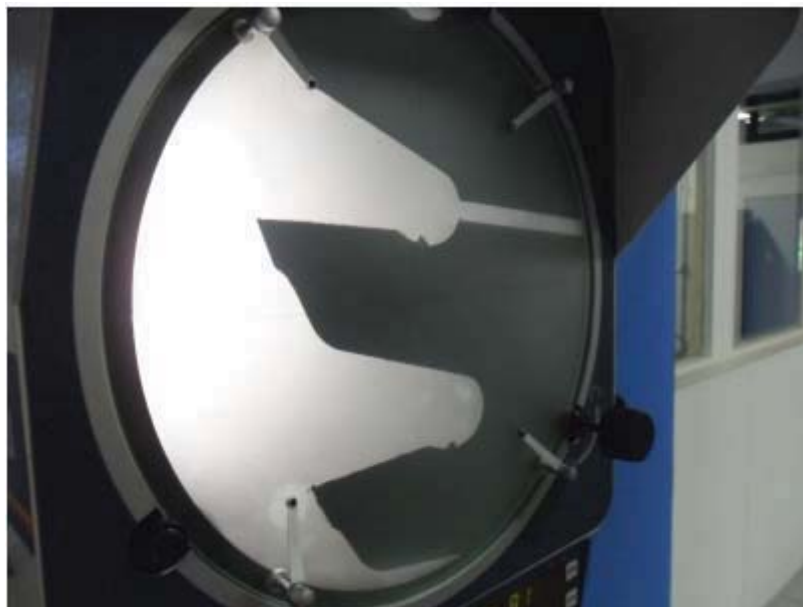
Figura 8.10 – Aferição do ângulo da serra depois da utilização.
