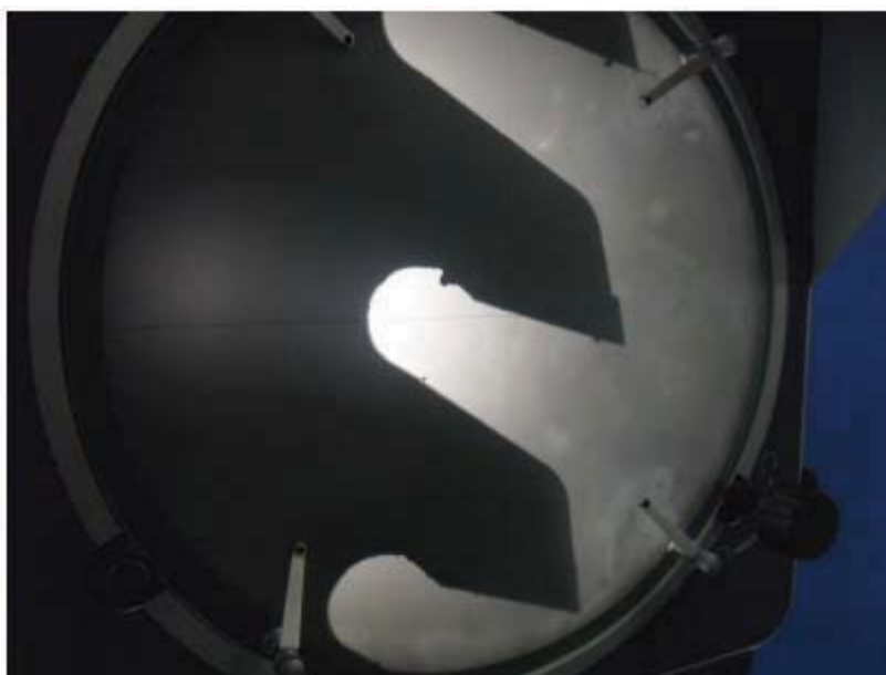
Figura 8.8 – Aferição do ângulo da serra antes da utilização.
