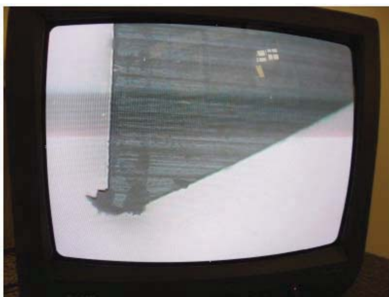
Figura 8.9 – Aferição da aresta cortante antes da utilização.
