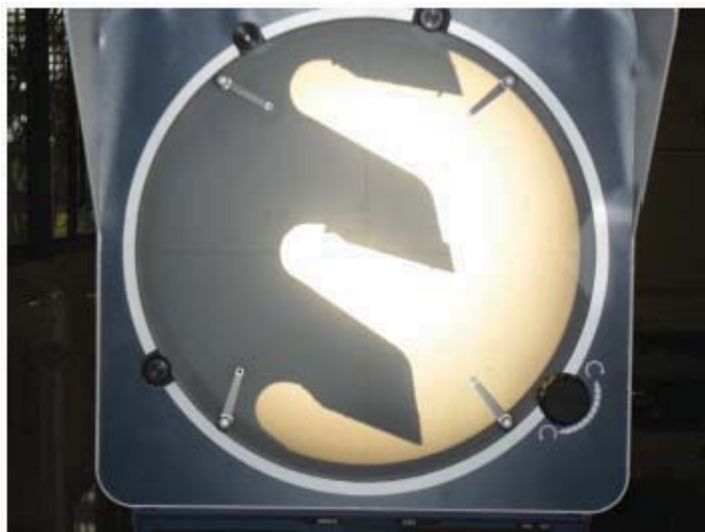
Figura 7.4 – Verificação das condições de afiação utilizando o projetor de perfil.
