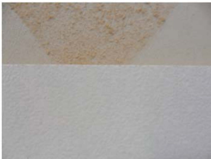
Figura 7.2 – Borda de uma chapa de MDF em perfeito estado apos o corte.
