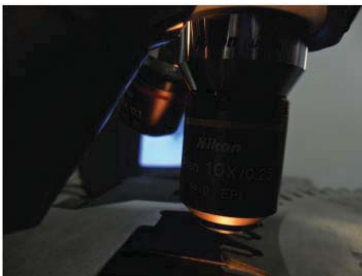
Figura 7.5 – Momento da verificação das condições de afiação utilizando o microscópio.
